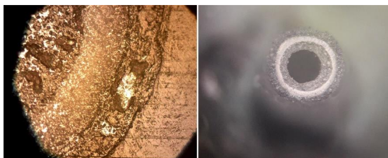
شکل ۶-۰: تصاویر از جداره ریزلوله
