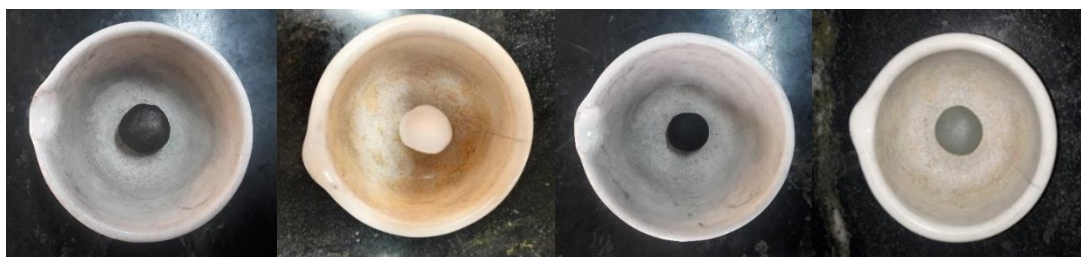
شکل ۶-۰: خمیرها از سمت راست به ترتیب آند، کاتد، الکترولیت و گرافیت
