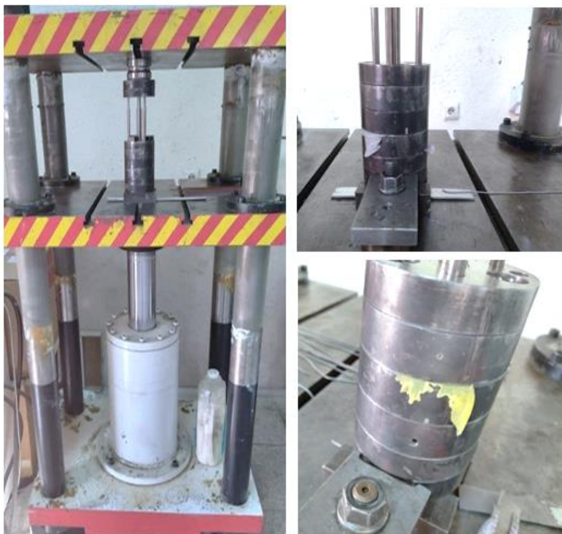
شکل ۱-۰: مراحل اکسترودر ریز لوله سرامیکی با بیرون زدگی خمیر لایه‌ها
