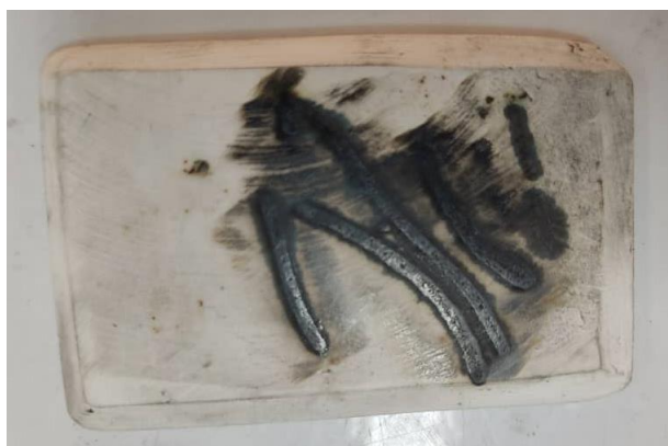
شکل ۵-۰: نمونه تفجوشی شده در دمای 1550^{\circ}\text{C}
