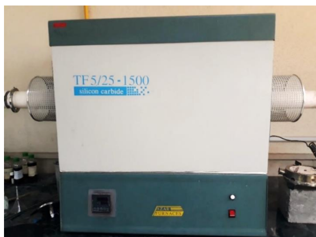
شکل ۱۲-۲: کوره لوله‌ای اتمسفر کنترل
