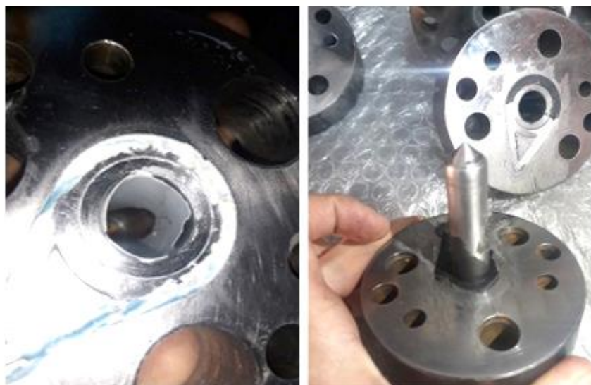
شکل ۳-۰: عیوب جریان خمیر در محفظه‌ها
