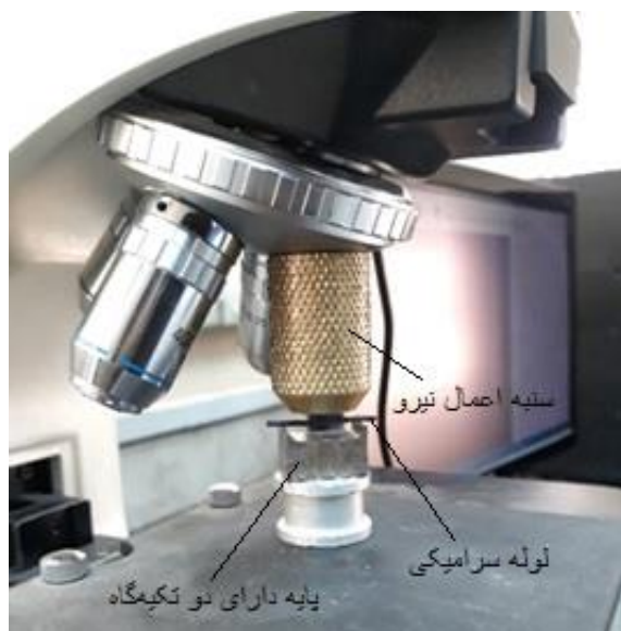
شکل ۱۷-۰: تصویر نگه‌دارنده نمونه طراحی‌شده برای انجام آزمون خمش سه‌نقطه
