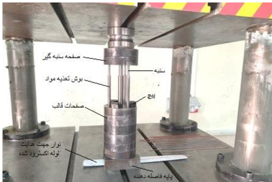
شکل ۲-۰: اکستروژد بعد از اصلاحات قالب بدون بیرون زدگی خمیر
