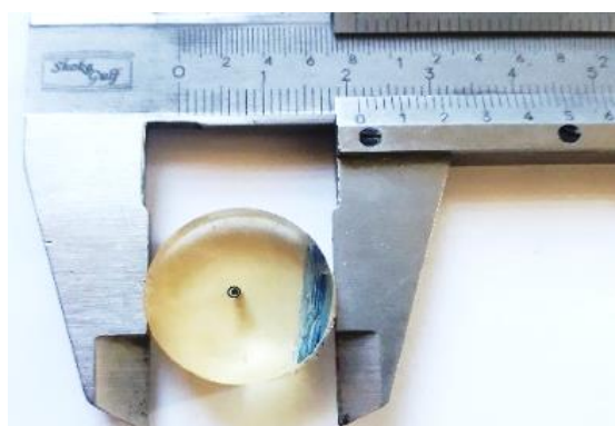
شکل ۱۳-۲: نمونه مانت شده
