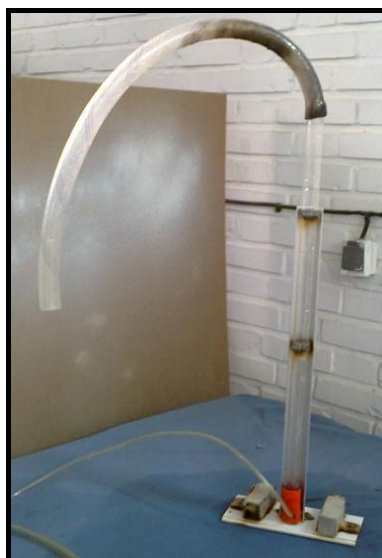
شکل (۳-۲۰) لوله تخلیه و لوله هوا
