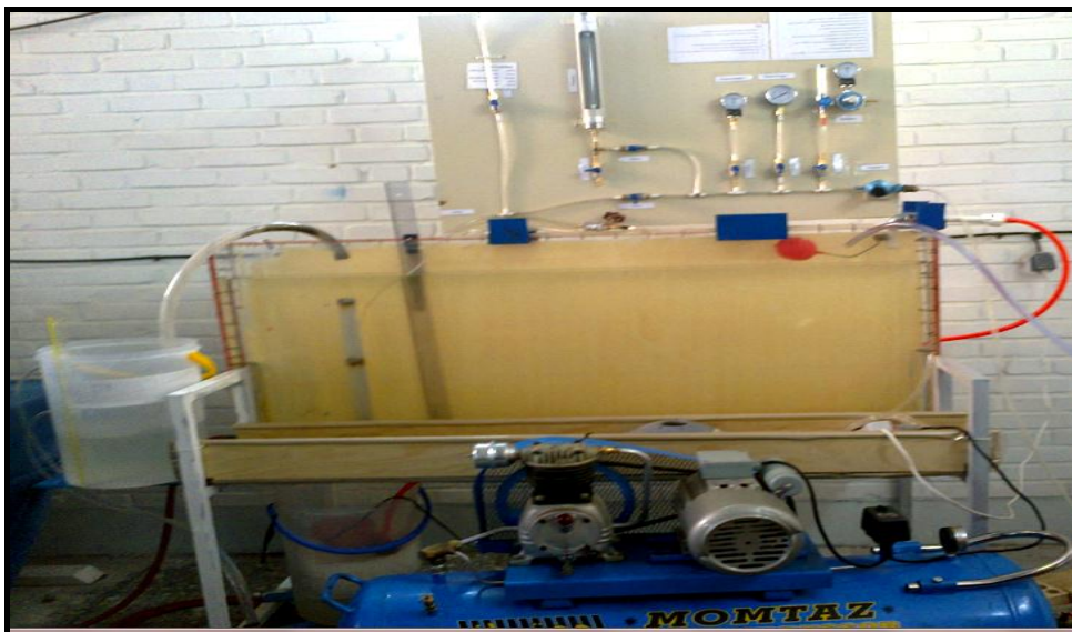
شکل (۳-۲۹) مونتاژ نهایی پمپ بالابر بادی
