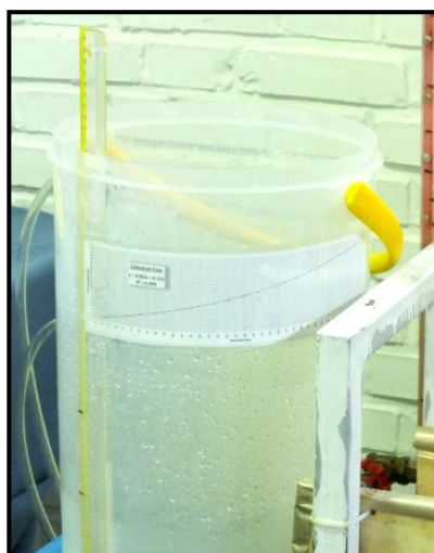
شکل (۳-۲۶) مخزن اندازه گیری دبی آب خروجی
