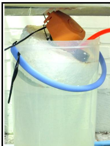
شکل (۳-۲۵) پمپ آب برگشت
