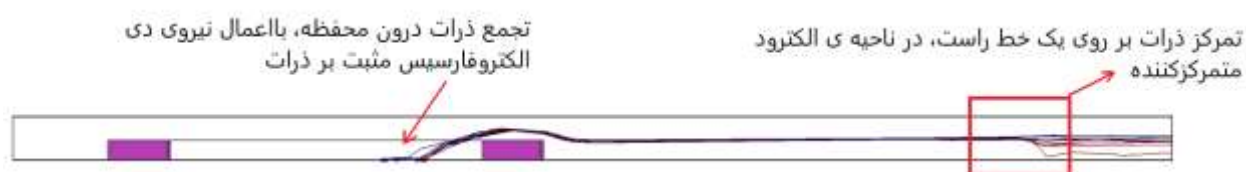
شکل ۵-۹ تحلیل عددی میکروکانال مورد مطالعه را نشان می‌دهد. سیگنال سینوسی اعمال شده به الکتروود متمرکز کننده در ولتاژ ۴۶ ولت و فرکانس ۲/۱ مگاهرتز، سیگنال سینوسی اعمال شده به الکتروود داخل محفظه با ولتاژ ۵۰ ولت و فرکانس ۱ کیلوهرتز می‌باشد.
