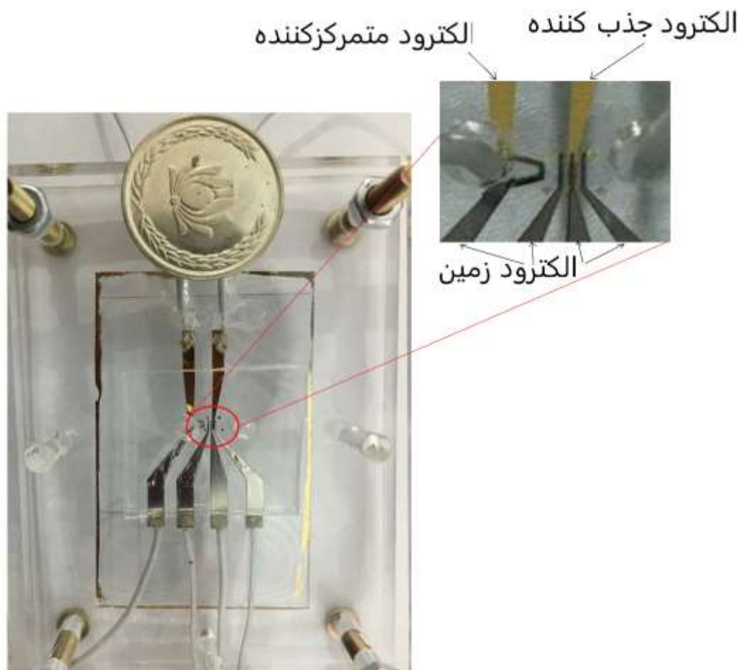
شکل ۵-۶ میکروکانال ساخته شده در پژوهش مورد مطالعه
