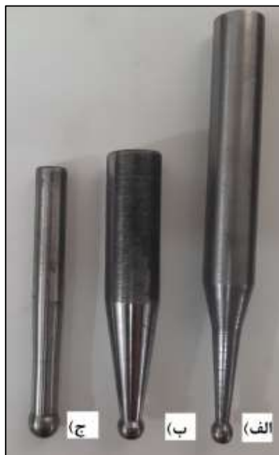
شکل ۳-۵. ابزار سر کروی با قطرهای (الف) ۸ (ب) ۱۰ و (ج) ۱۲ mm
