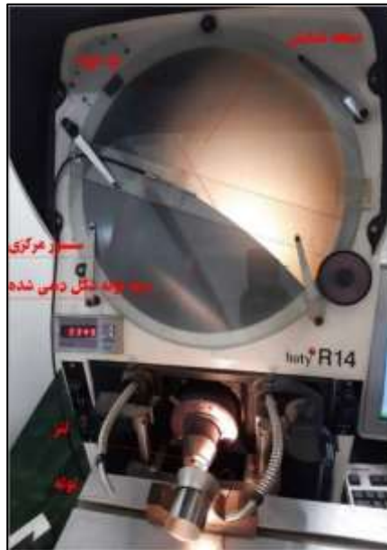
شکل ۳-۱۴. نحوه قرارگیری لوله منبسط شده در پروفایل پروژکتور مدل Baty R14
