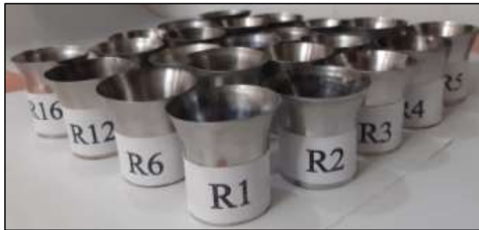
شکل ۴-۳. نمونه لوله‌های شکل‌دهی شده بر اساس طراحی آزمایش
