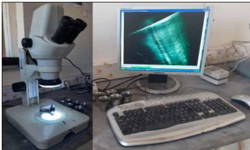
شکل ۳-۱۶. دستگاه استریو میکروسکوپ نوری
