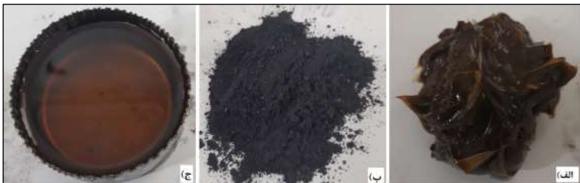
شکل ۳-۶. نوع روانکار (الف) گریس معمولی (ب) پودر گرافیت و (ج) روغن معمولی
