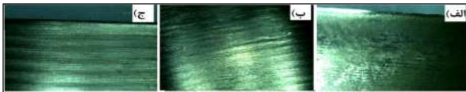
شکل ۵-۲۴. کیفیت سطح با گام عمودی الف (۰,۲ ب) ۰,۵ و ج (۰,۸ mm
