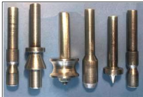
شکل ۲-۶. انواع ابزارهای مورد استفاده برای شکل‌دهی انتهای لوله در فرآیند SPIF [۴۲]
