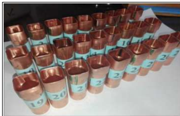
شکل ۲-۸. شکل‌دهی انتهای لوله‌های مسی با هندسه مربعی با استفاده از فرآیند SPIF [۴۶]
