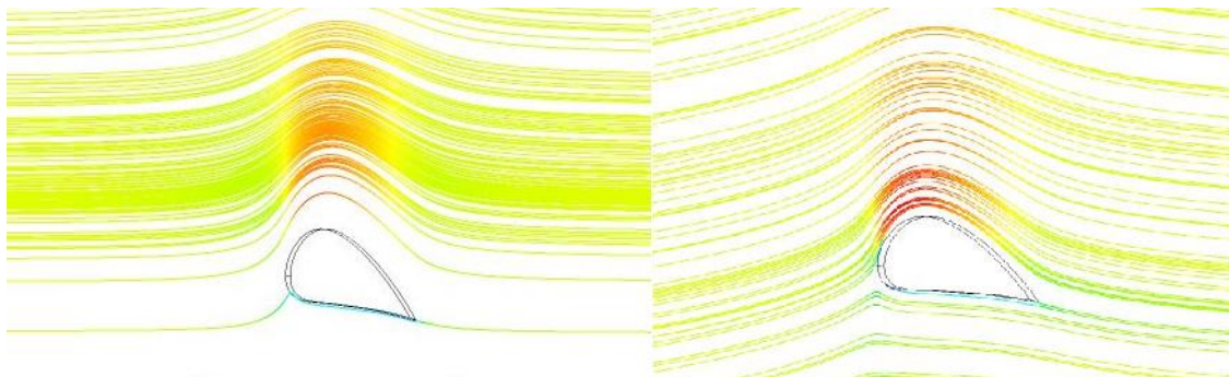
الف) تصویر بزرگنمایی شده خطوط جریان برای زاویه حمله ۴ درجه (تصویر سمت چپ حالت اثر زمین و تصویر سمت راست جریان آزاد می باشد)
