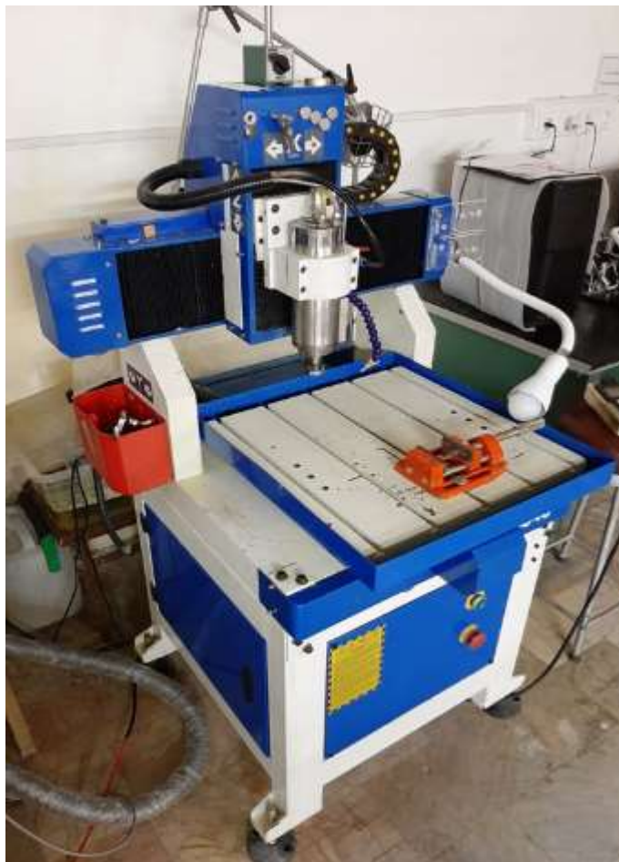
شکل ۲-۴ نمایی از دستگاه میکرومیلینگ مورد استفاده در تحقیق حاضر
