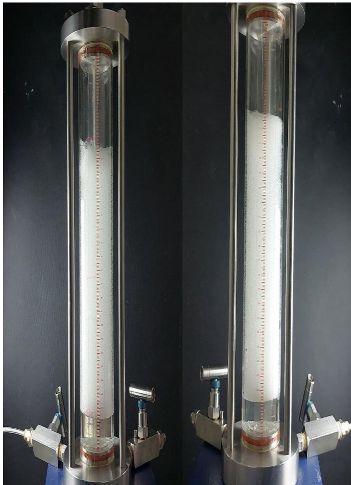
شکل ۴-۴. قابلیت فوم‌کنندگی فوم AOS: بدون شوری (راست)، با شوری (چپ)
