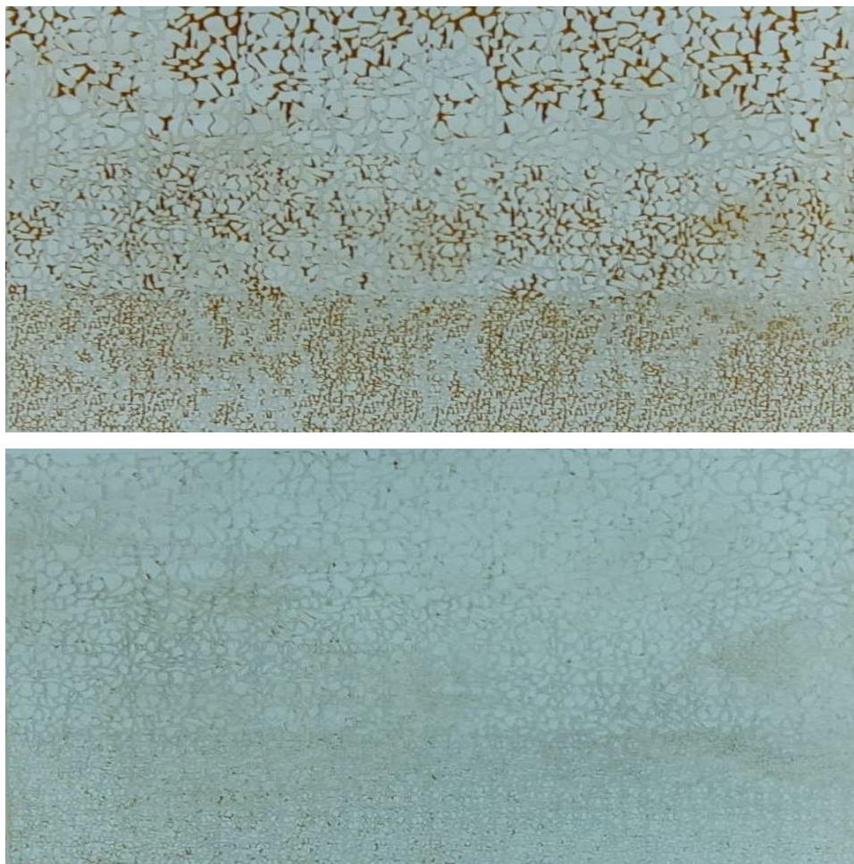
شکل ۴-۳۳. مقایسه میزان بازیابی انجام شده توسط فوم حاصل از سورفکتانت AOS (بالا، ۳۷/۶٪ بازیابی)
