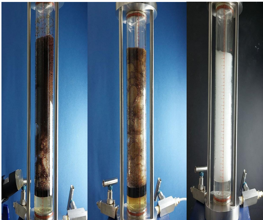
شکل ۴-۸. قابلیت فوم‌کنندگی فوم AOS: بدون نفت (راست)، با نفت (وسط)، با نفت و نانوذره (چپ)
