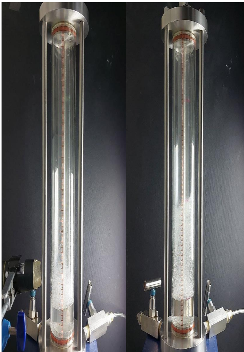
شکل ۴-۱۷. پایداری فوم AOS: بدون نانوذره (سمت راست)، با نانوذره (سمت چپ)
