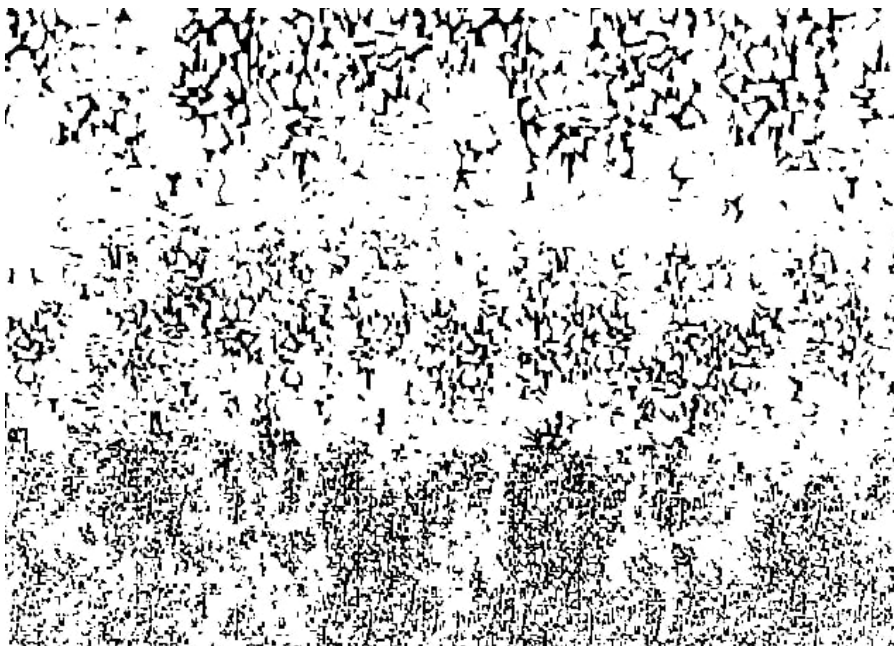
شکل ۴-۳۰. اتمام بازیابی پس از یک ساعت تزریق فوم AOS در میکرومدل
