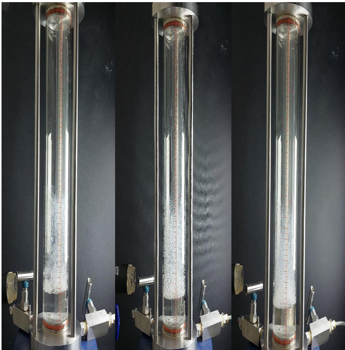
شکل ۴-۱۱. پایداری فوم AOS: ۱/۵ CMC (راست)، ۱ CMC (وسط)، ۰/۵ CMC (چپ)
