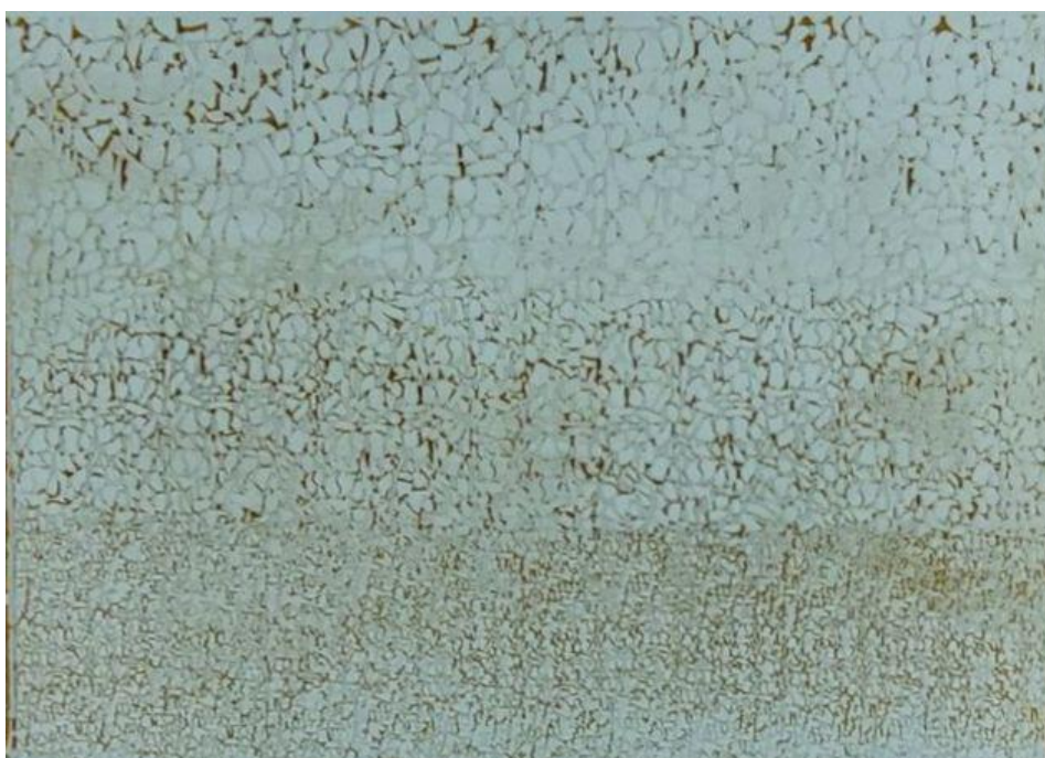
شکل ۴-۳۱. ده دقیقه پس از تزریق فوم AOS - نانوذره در میکرومدل
