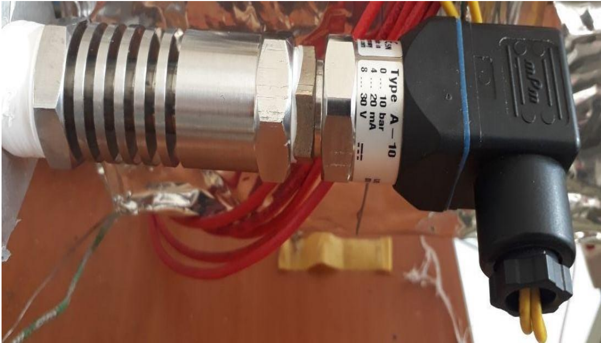
شکل ۳-۱۰: سنسور اندازه‌گیری فشار A-10
