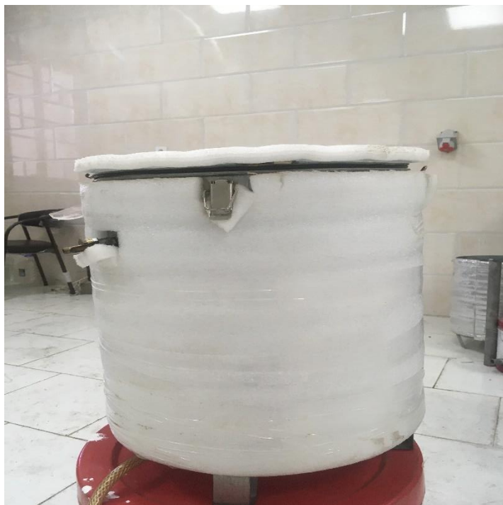
شکل ۴-۱۲: مخزن آب ۵۰ لیتری استفاده شده در آزمایش‌ها
