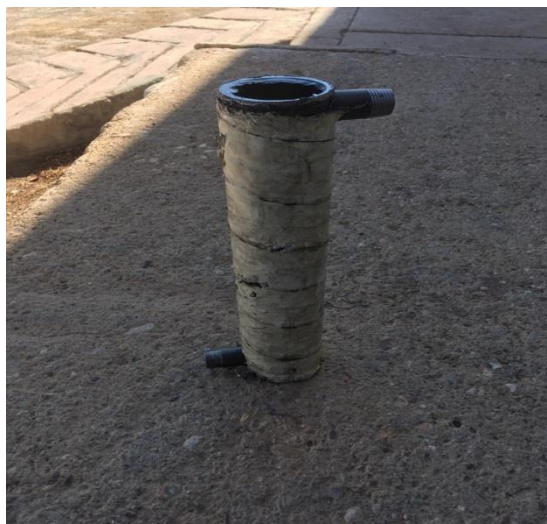
شکل ۴-۶: لوله‌ی فولادی به کار رفته به عنوان چگالنده ترموسیفون
