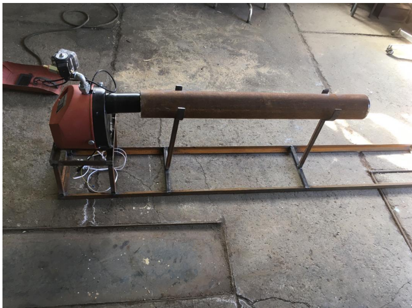
شکل ۴-۹: جانمایی مشعل و پایه‌گذاری برای لوله افقی
