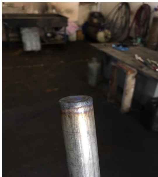
شکل ۴-۱: انتهای بسته شده لوله استیل
