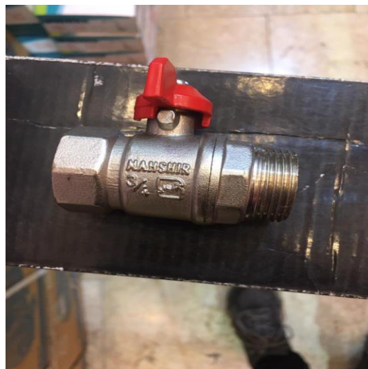
شکل ۴-۳: شیر به کار رفته در ترموسیفون
