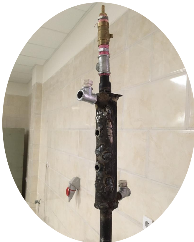
شکل ۴-۷: نمایی از کندانسور جوش داده شده به ترموسیفون
