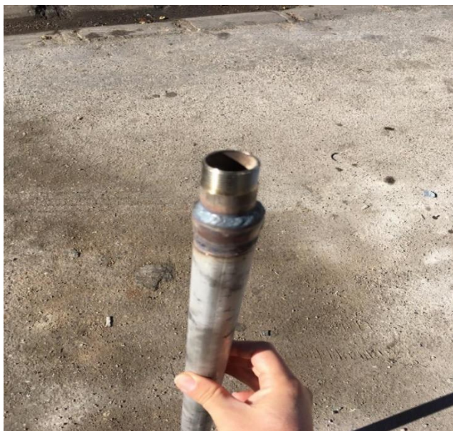
شکل ۴-۲: اتصال رابط یکسر رزوه‌دار به ترموسیفون
