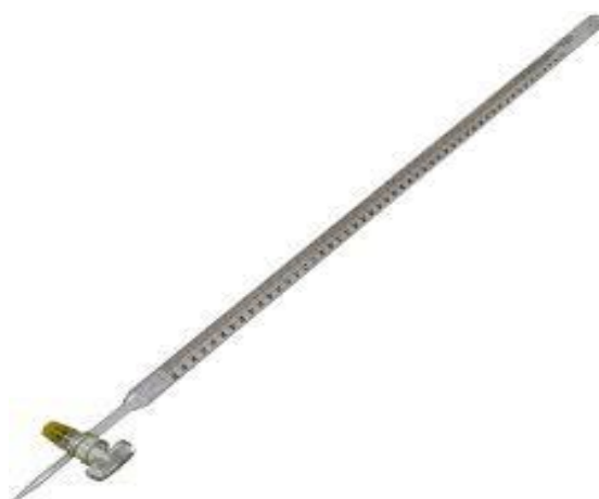
شکل ۴-۱۹: بورت استفاده شده در آزمایش‌ها
