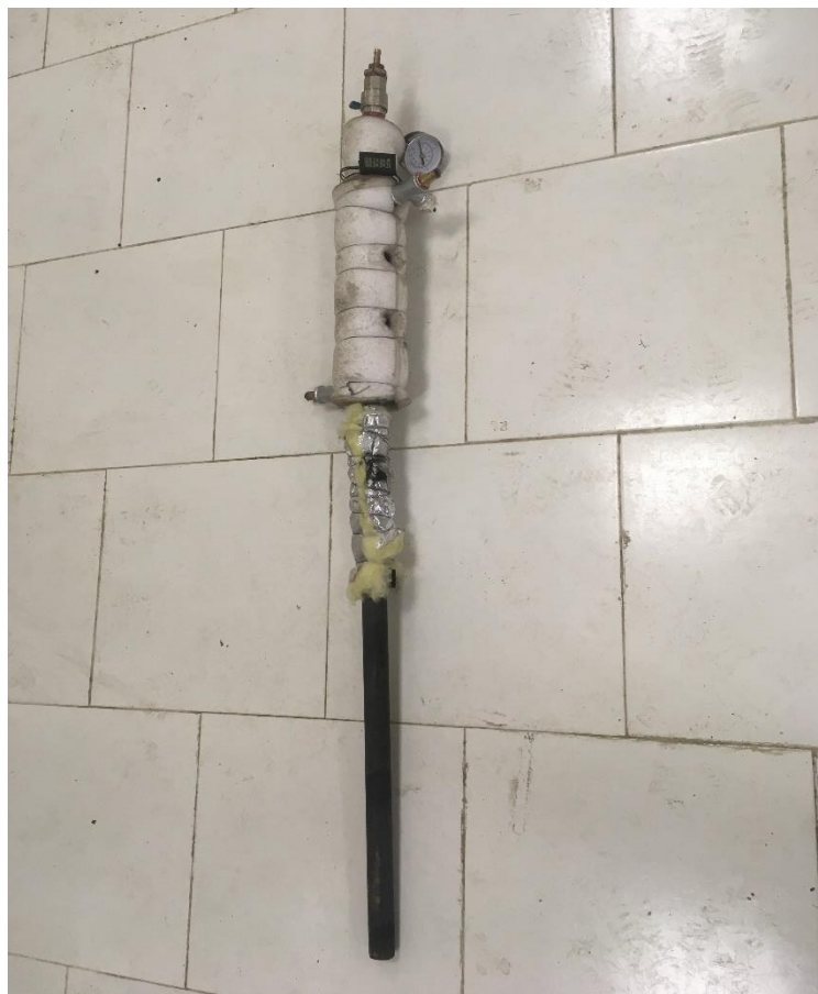
شکل ۴-۸: ترموسیفون ساخته شده
