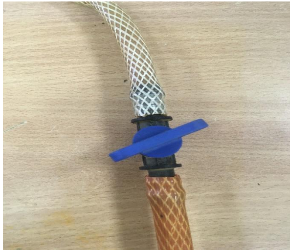
شکل ۴-۱۳: شیر به کار رفته جهت تنظیم دبی آب
