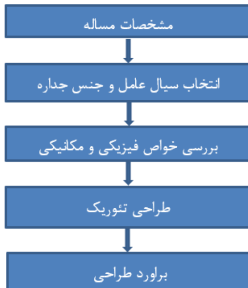
شکل ۱-۳: شماتیک طراحی لوله گرمایی [۳]
