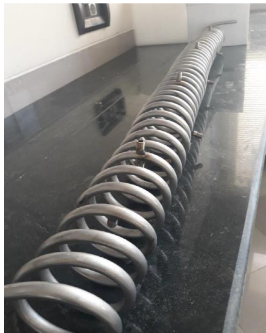
شکل ۳ - ۹: نمایی از کویل و مهره‌های جوش داده شده و آرایش مقاطع
