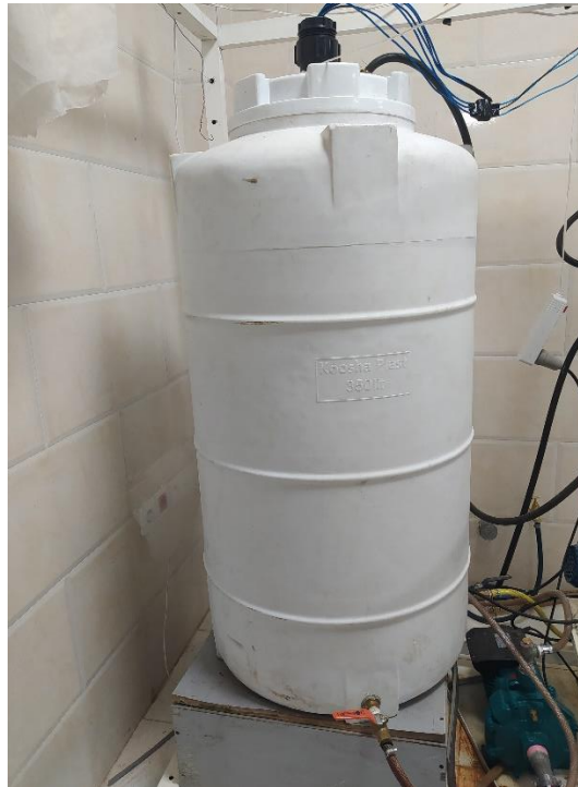
شکل ۳-۱۲: مخزن پیش گرم کن با حجم ۳۵۰ Lit و جنس پلی اتیلن
