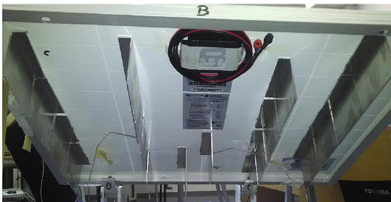
شکل ۱-۵. خنک کاری پنل با اتصال پره های آلومینیومی به سطح پشتی پنل خورشیدی [۵]
