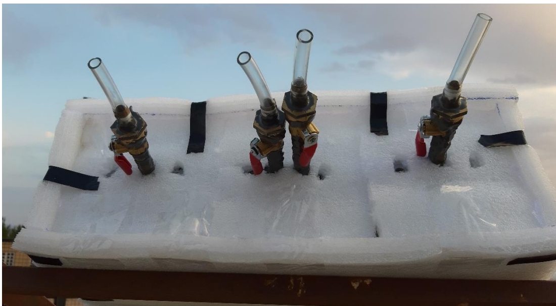
شکل ۳-۱۱. تکمیل فرایند عایق کاری با نصب عایق ۲ سانتی متری به دور مخازن
