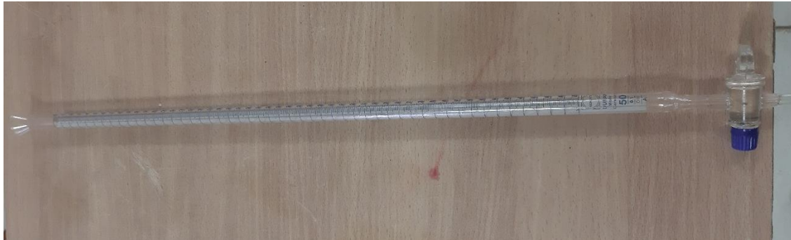
شکل ۳-۱۴. بورت مورد استفاده جهت تزریق سیال به لوله‌های گرمایی
