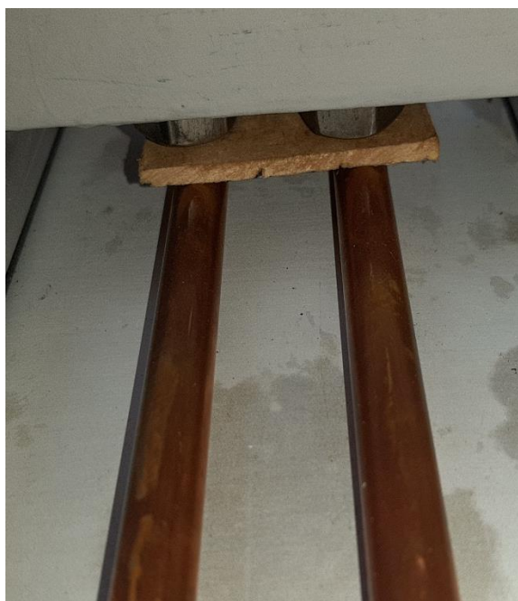
شکل ۳-۸. مکانیزم اتصال دو لوله گرمایی به پشت پنل
