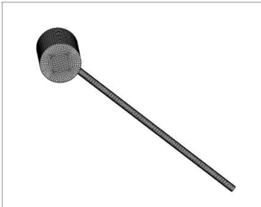
شکل ۴-۶ نمای کلی از شبکه‌بندی هگزاهدرال ۱ روی هندسه مدل
