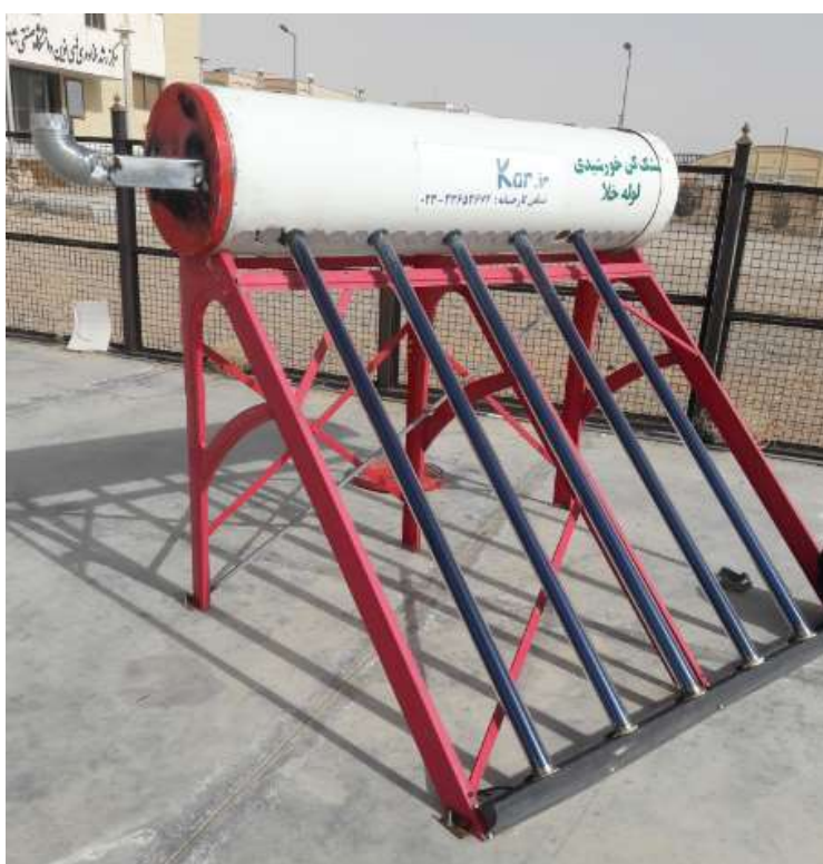
شکل ۲-۳ نمایی از ساختار کلکتور خورشیدی مورد مطالعه در آزمایشگاه
