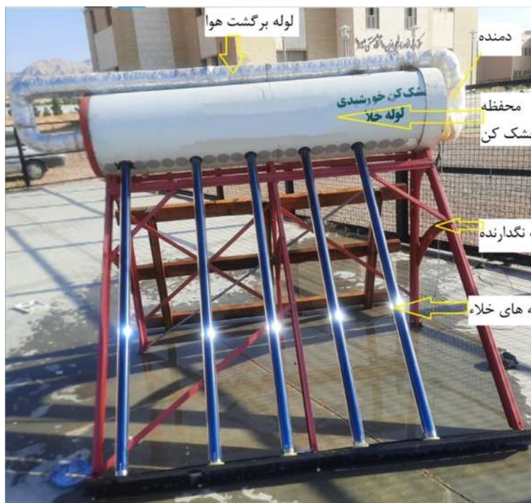
شکل ۲-۱۲ نمایی از کلکتور خورشیدی لوله خلأ مورد مطالعه
