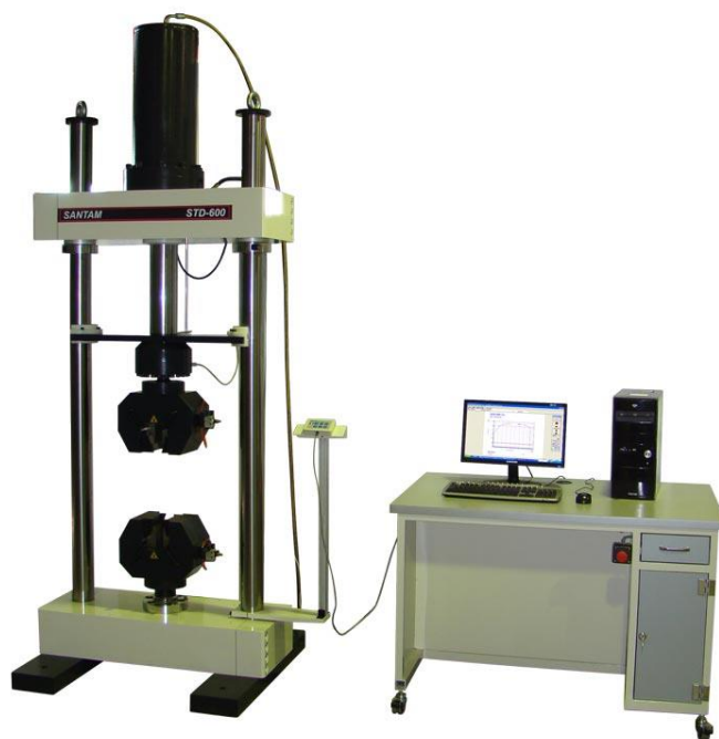
شکل (۲-۲) نمای کلی دستگاه کشش-فشار سنتام STD-600 [۳۳]
