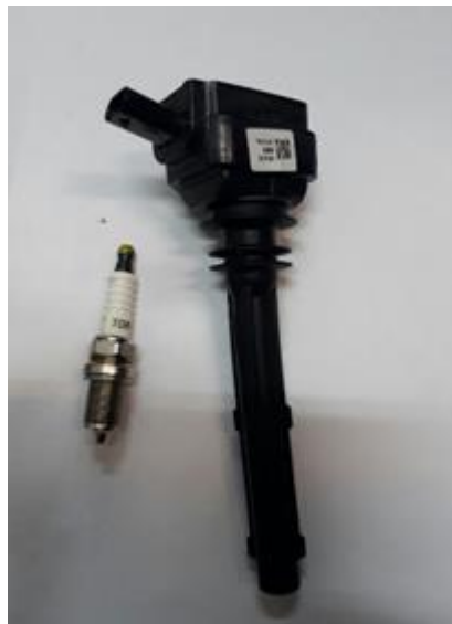
شکل ۴-۶: نمونه ای از شمع و کوئل مورد استفاده در آزمون احتراق
