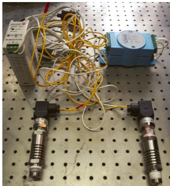
شکل ۹-۴: حسگر اندازه گیری فشار احتراق و دستگاه ثبت کننده اطلاعات
