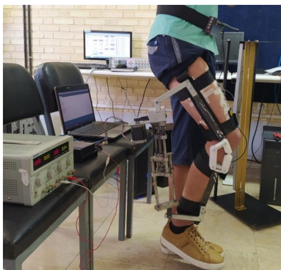
شکل ۲-۲. ربات اسکلت خارجی یاری گر زانو به همراه عملگر الاستیک سری
