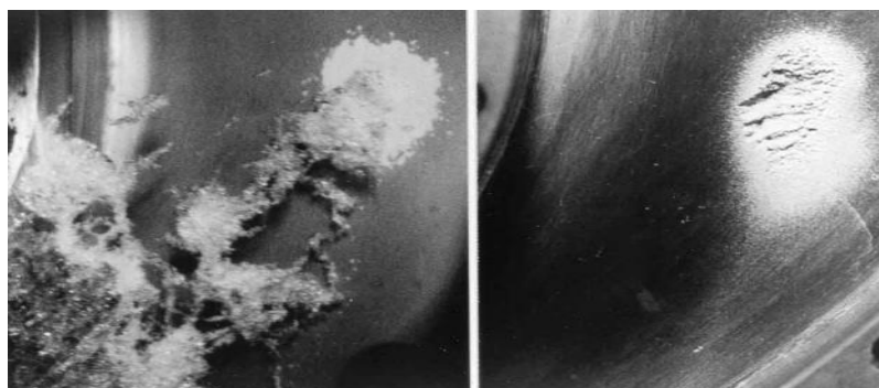
شکل ۱-۱۴: اثر تخریبی کاویتاسیون بر هاب یک پمپ سانتریفیوژ [۶]
