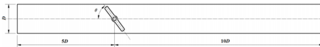
شکل ۱-۲: نمای دوبعدی از شیر پروانه‌ای [۱۴]
