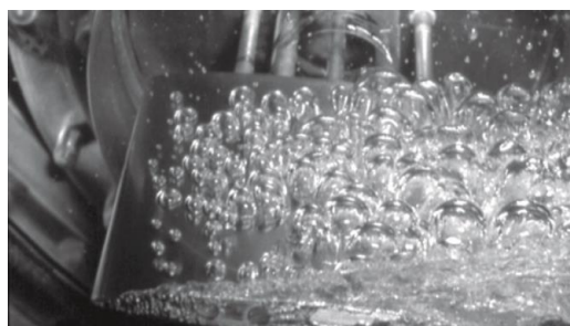
شکل ۱-۱۱: وقوع کاویتاسیون با حباب‌های انتقالی در هیدروفویل با زاویه حمله بالا [۶]
