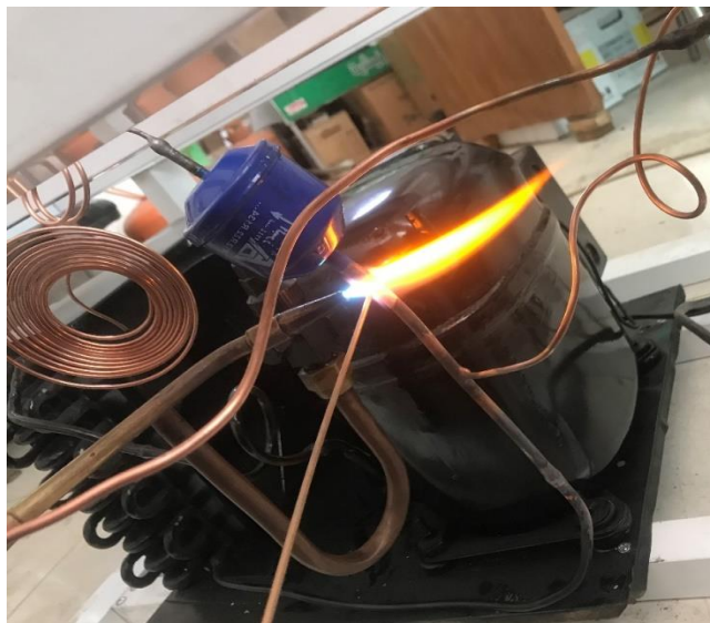
شکل ۳-۳. کمپرسور رفت و برگشتی و جوشکاری لوله های مسی ورودی و خروجی
