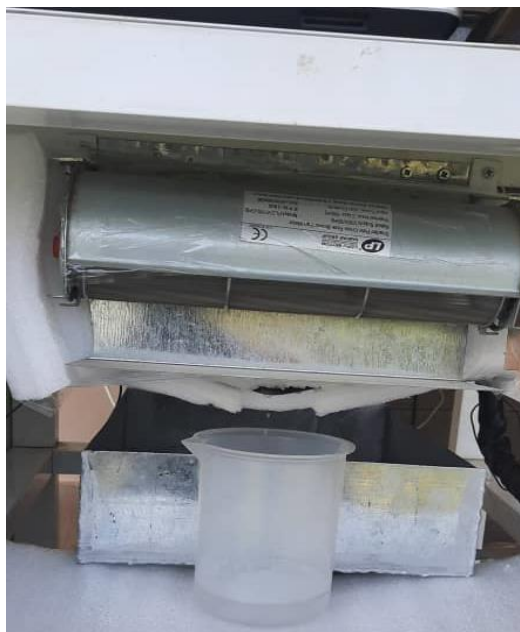
شکل ۱۲-۳. نحوه اندازه گیری تولید لحظه آب در دستگاه
