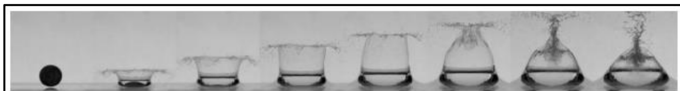
شکل ۲-۱۱: روند شکل‌گیری پرده پاشش آب توسط گوی فولادی [۴۵]
