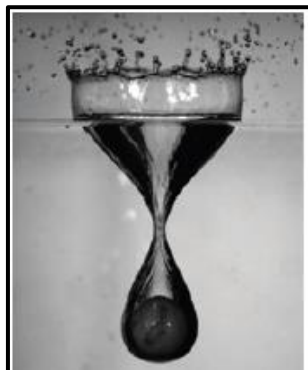
شکل ۲-۱۶: تشکیل کاواک با مکانیسم نفوذ هوا در اثر سقوط توپ بیلارد در آب [۴۲]
