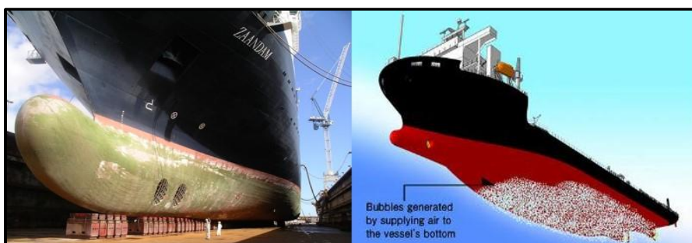
شکل ۱-۲: استفاده از تزریق هوا در کشتی جهت کاهش نیروی پسا [۴]
