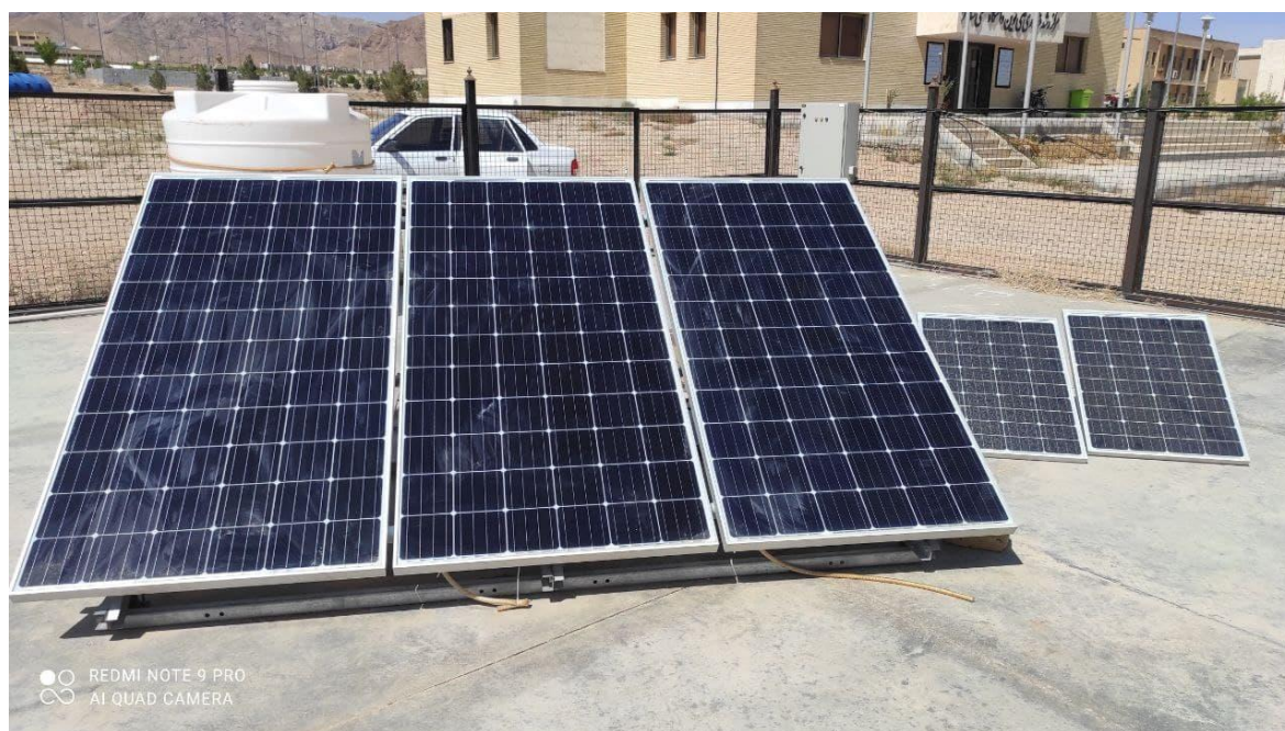
شکل ۳-۶: پنل‌های خورشیدی مورد استفاده جهت تامین شدت جریان‌های بین ۱۰ تا ۳۰ آمپر
