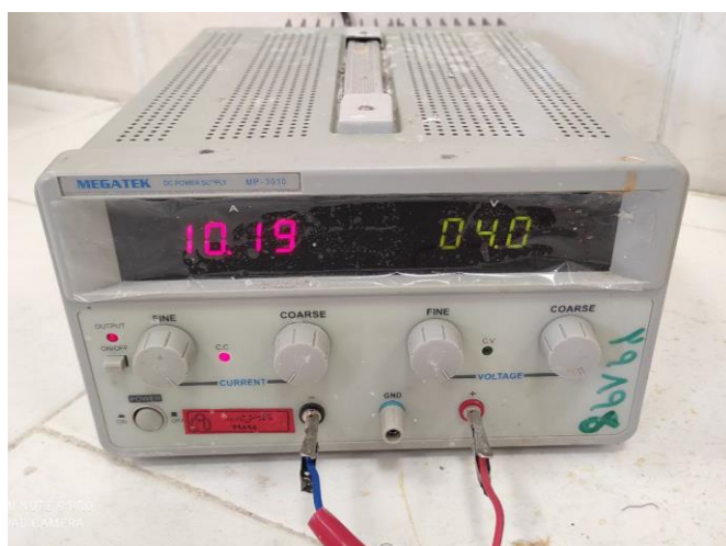
شکل ۳-۵: منبع تغذیه مورد استفاده برای شدت جریان‌های الف) بالاتر از ۳۰ آمپر و ب) کمتر از ۱۰ آمپر
