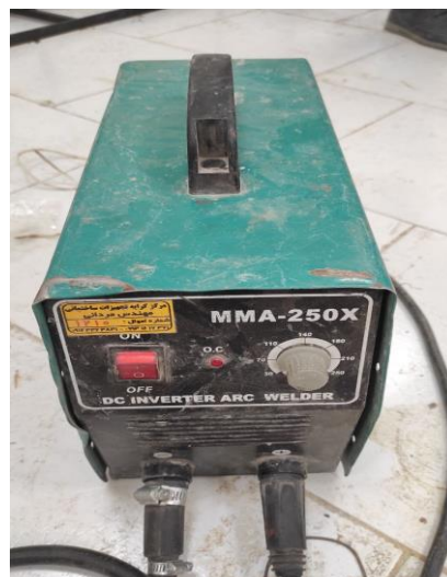
شکل ۳-۵: منبع تغذیه مورد استفاده برای شدت جریان‌های الف) بالاتر از ۳۰ آمپر و ب) کمتر از ۱۰ آمپر
