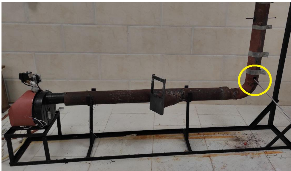
شکل ۳-۱۱: نحوه ارزیابی گازهای خروجی توسط دستگاه آنالیزور دود
