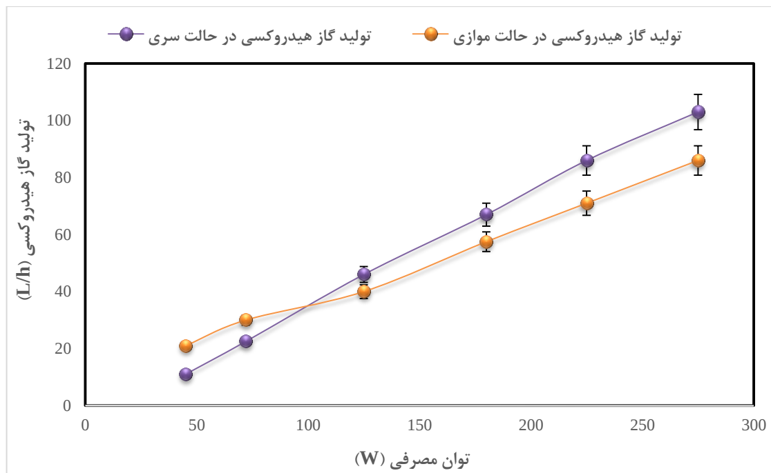
شکل ۴-۹: تولید گاز هیدروکسی بر حسب توان مصرفی در حالت آرایش سری و موازی صفحات الکترولایزر
