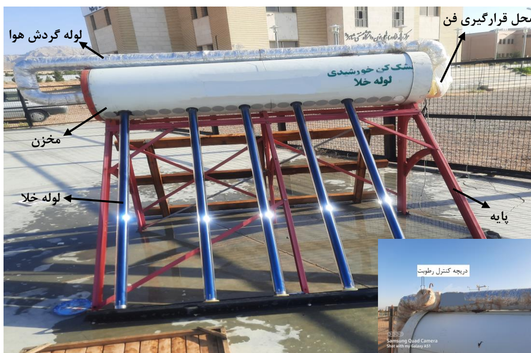
شکل ۳-۲ خشک‌کن خورشیدی لوله خلاء
