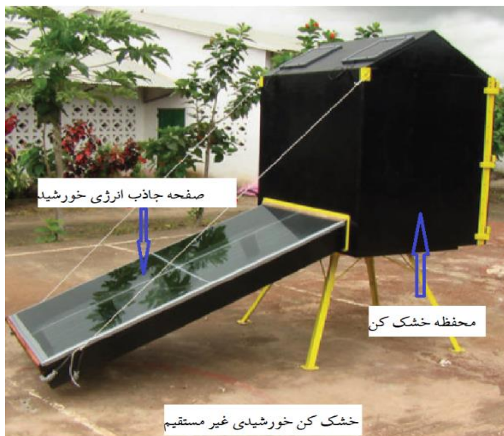
شکل ۱۲-۱ دستگاه خشک کن خورشیدی غیرمستقیم [۸]
