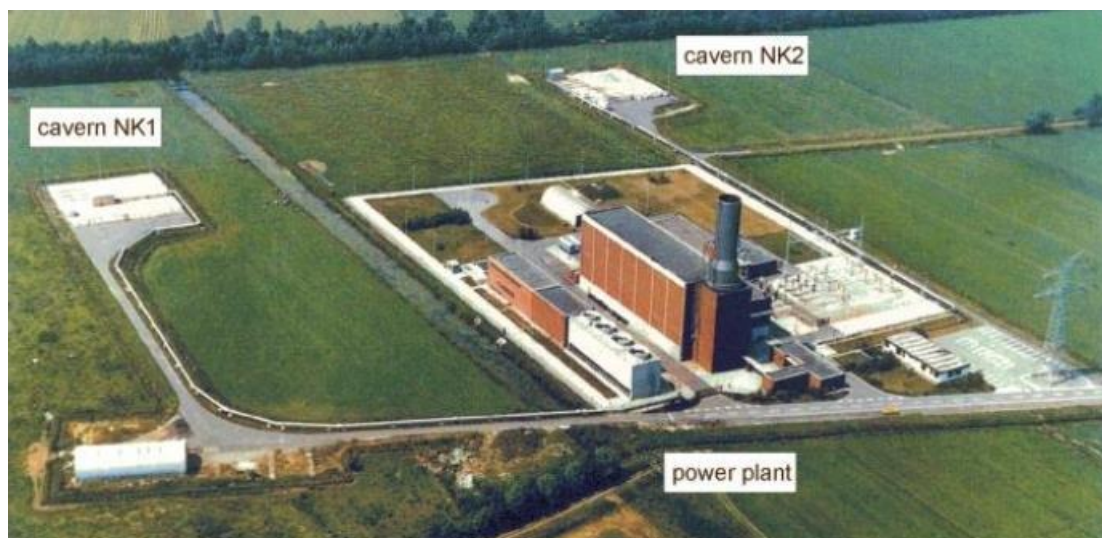
شکل (۸-۱): نمایی از نیروگاه هانتورف آلمان با دو مخزن ذخیره هوای فشرده
