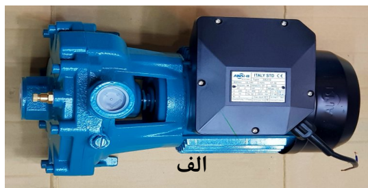
شکل ۳-۹: پمپ آب الف) پمپ پساب ساخت شرکت ANSHI ب) پمپ آب تغذیه و کندانسور ساخت شرکت PENTAX
