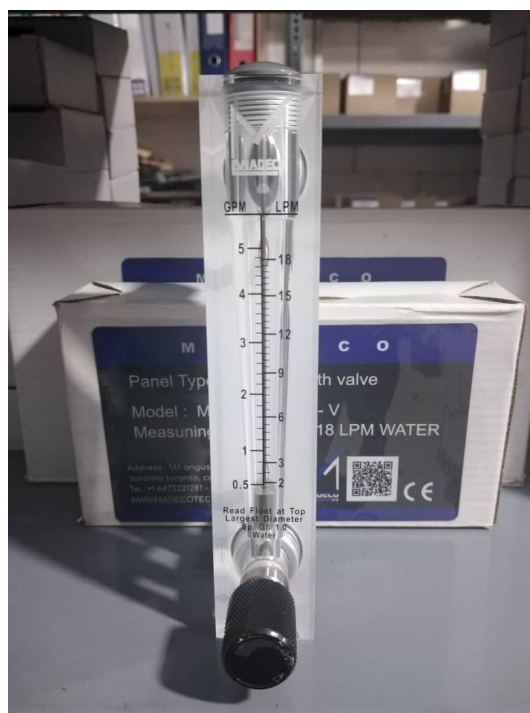
شکل ۳-۱۱: روتامتر ساخت شرکت MADECO کانادا
