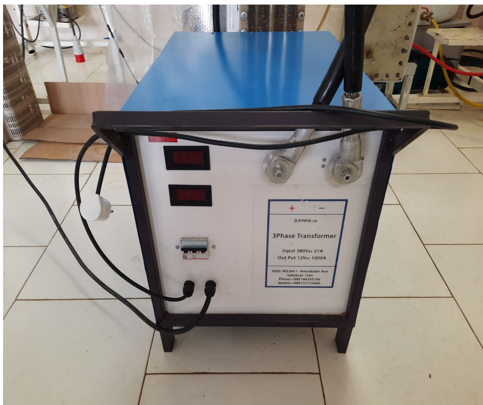
شکل ۳-۶: ترانس کاهنده ولتاژ سه فاز جریان مستقیم
