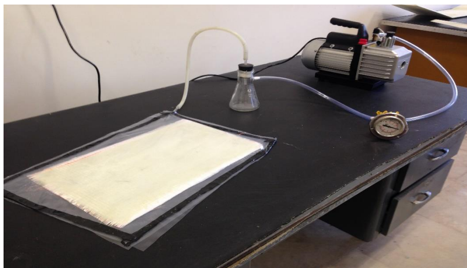
شکل (۳-۱۱) ورق کامپوزیت شیشه تحت خلاء
