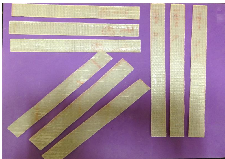
شکل (۳-۱۳) نمونه‌های آزمایش کشش شیشه/اپوکسی
