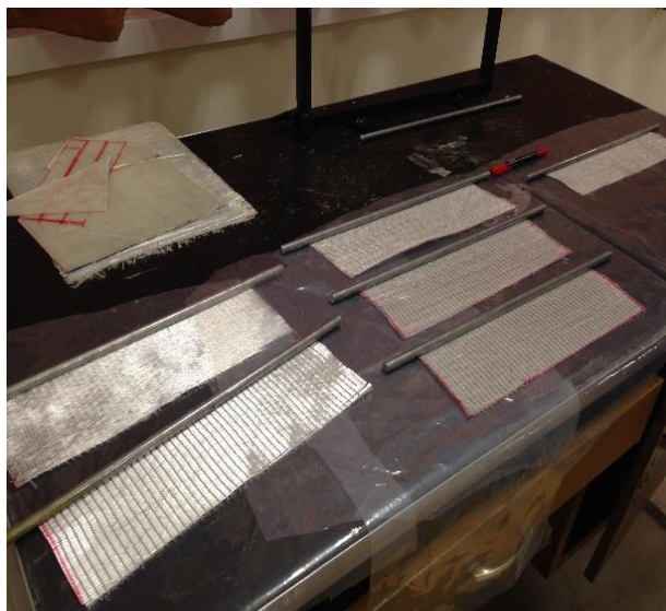
شکل (۳-۱۵) ستون تقویت شده با الیاف شیشه، رزین اپوکسی و نانو ذره کربن چند دیواره
