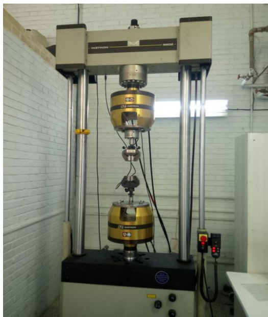
شکل (۳-۹) دستگاه هیدرولیک اینسترون
