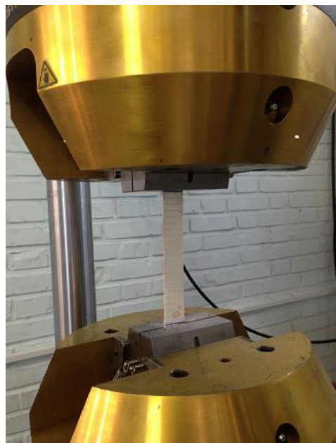
شکل (۳-۱۶) نمونه قرار داده شده در دستگاه اینسترون برای آزمون کشش ساده
