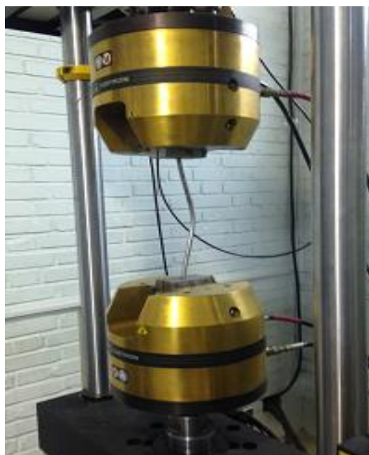
شکل (۳-۱۷) نمونه قرار داده شده در دستگاه اینسترون برای آزمون فشار
