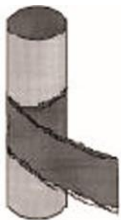
شکل (۱۰-۱) پوشش طولی ستون با مقطع دایره‌ای [۱۱]
