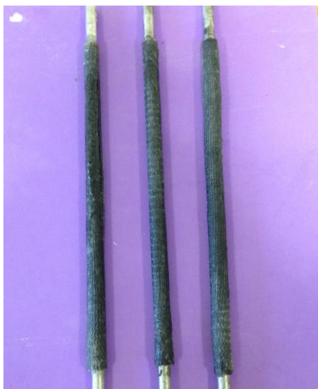
شکل (۳-۱۵) ستون تقویت شده با الیاف شیشه، رزین اپوکسی و نانو ذره کربن چند دیواره
