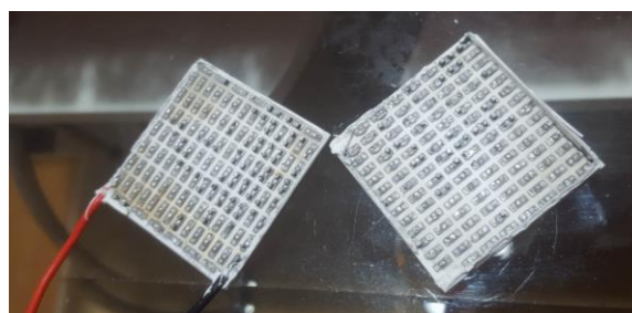
شکل ۴-۱۰ نمای داخلی TEC از کار افتاده
