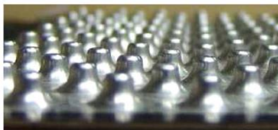
شکل ۲-۳: نمایش آرایش و میزان تراکم قرارگیری پین‌ها در ناحیه بالایی کانال مورد مطالعه بانکر [۲۲]
