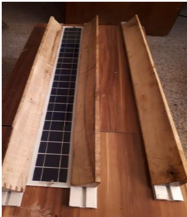
شکل ۴-۴ حکاکی پروفیل متمرکزکننده سهموی مرکب طراحی شده بر روی چوب توسط CNC
