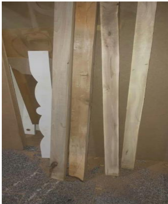
شکل ۳-۴ چوب‌های درخت گردوی استفاده شده در ساخت تکیه‌گاه متمرکزکننده سهموی مرکب
