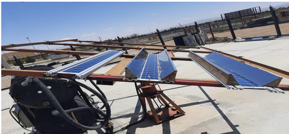
شکل ۴-۸ نمونه آزمایشگاهی ساخته شده سیستم فتوولتاییک-متمرکز کننده سهموی مرکب
