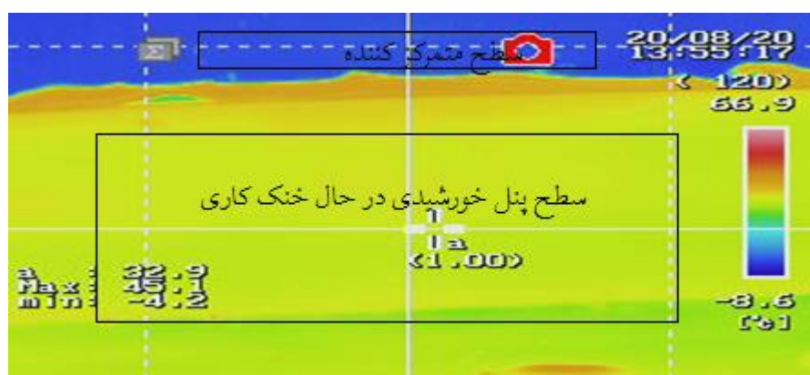
شکل ۵-۷ تصویر ترموگرافی پنل خورشیدی با متمرکزکننده و خنک کاری
