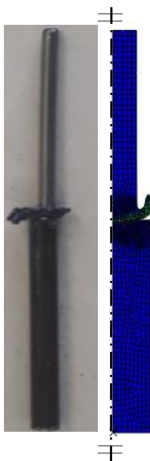
شکل ۴-۱۵ مقایسه آزمون تجربی و عددی برای بررسی مقدار پلیسه ایجاد شده
