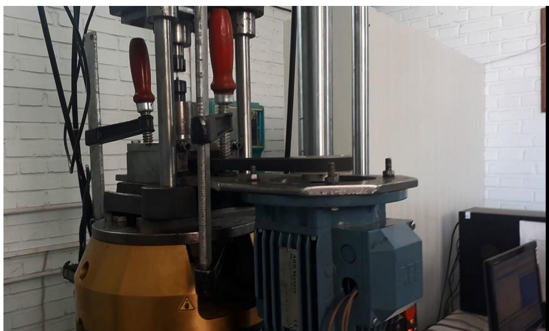
شکل ۲-۳ دستگاه کشش تک محوره اینسترون ۸۸۰۲ سروهیدرولیک
