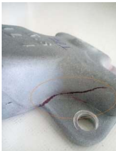
شکل ۳-۱۷: شناسایی ناحیه ترک خورده با آزمون مایع نافذ V01T07 [۳۰]
