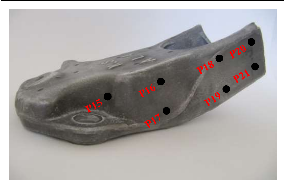
شکل ۴-۶: ضخامت سنجی از نمونه های آزمایش (آزمون غیر مخرب فراصوت)
