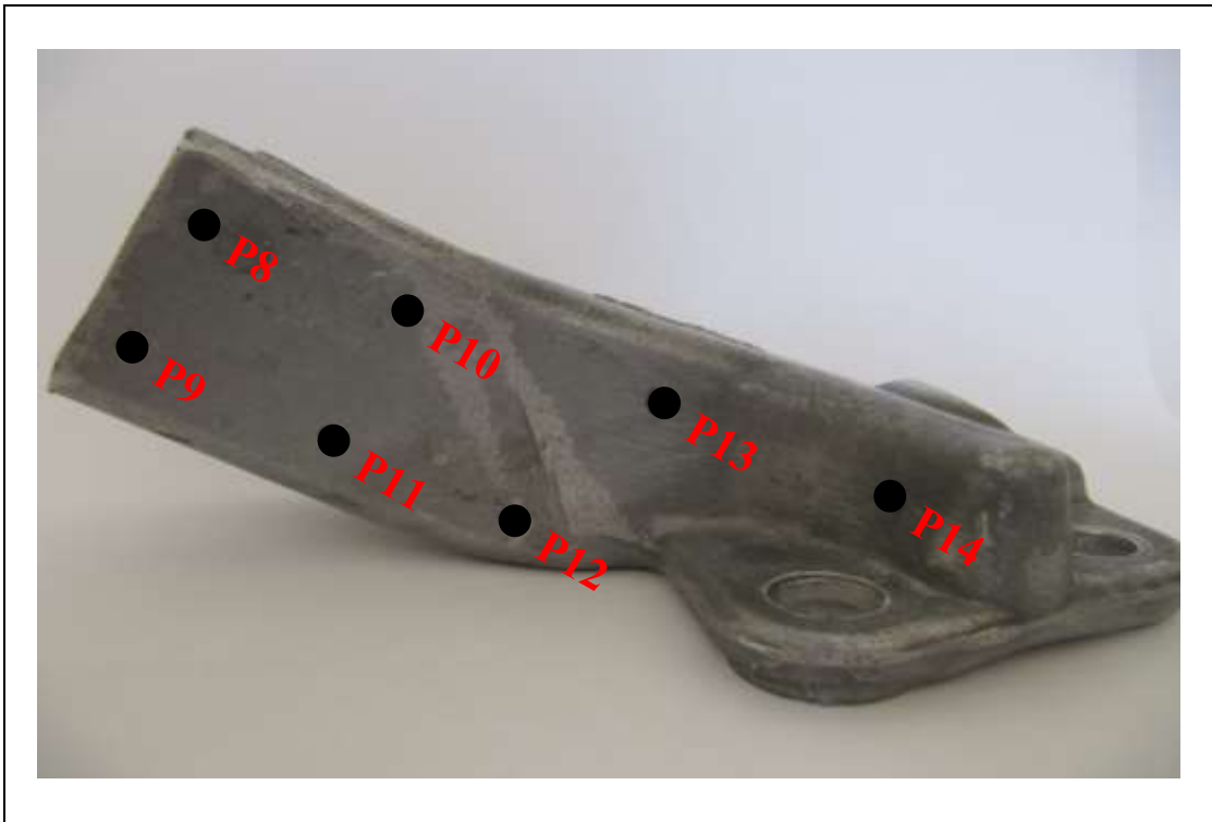
شکل ۴-۴: ضخامت سنجی از نمونه های آزمایش (آزمون غیر مخرب فراصوت)
