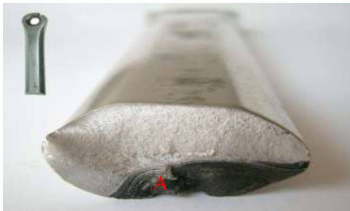
شکل ۱-۶: اثر شکست یک بازوی لنگ آلومینیومی تحت بار گذاری خستگی، A نشانه‌های ساحلی
