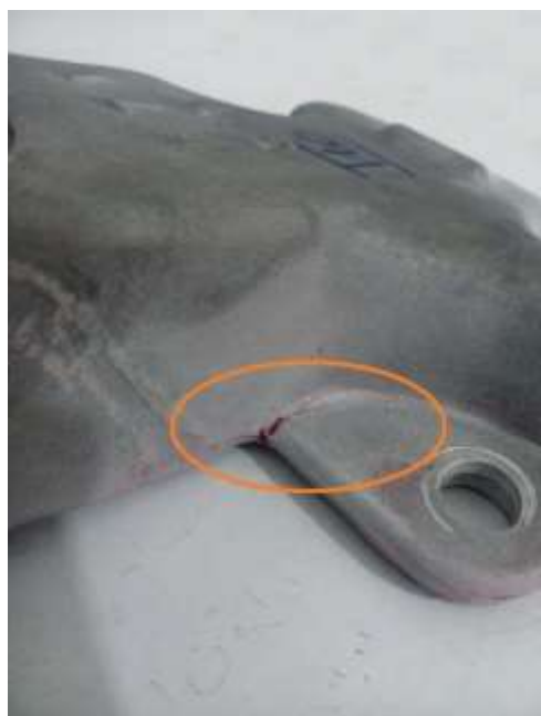
شکل ۳-۱۹: شناسایی ناحیه ترک خورده با آزمون مایع نافذ V01T10 [۳۰]
