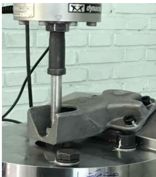
شکل ۳-۲: فیکسچر و دسته موتور نصب شده بر روی دستگاه اینسترون برای انجام آزمون خستگی [۳۰]
