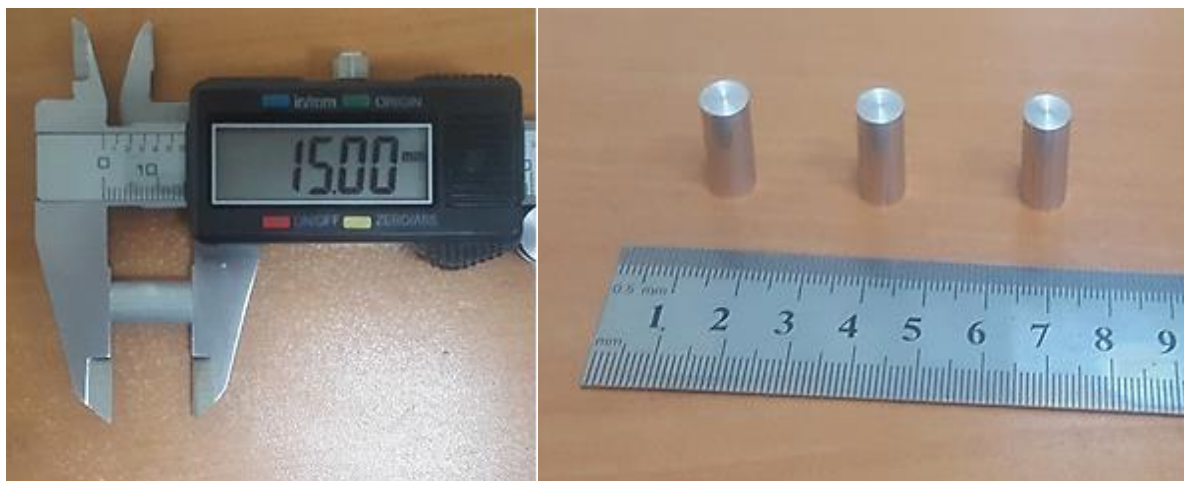
شکل ۱-۲ نمونه‌های اولیه آماده شده جهت اجرای فرایند آنیل و آزمون فشار
