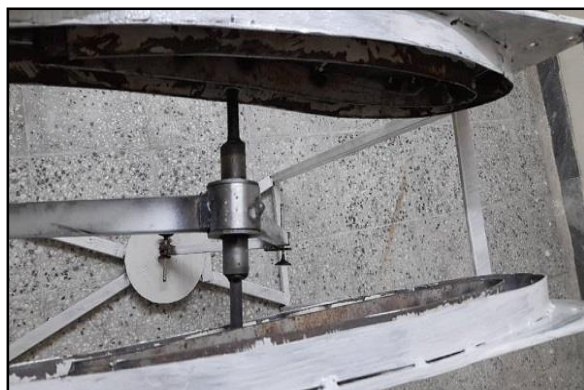
شکل ۵-۱۹: طراحی لینک رابط دو صفحه و غلتک مورد استفاده در شیار
