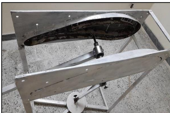
شکل ۵-۱۹: طراحی لینک رابط دو صفحه و غلتک مورد استفاده در شیار
