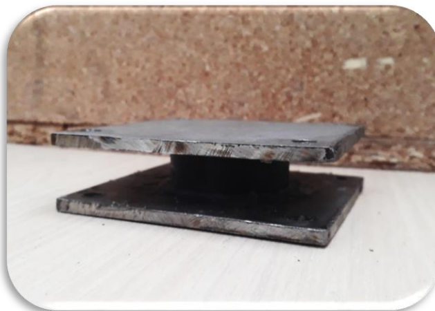
شکل ۲۱-۲- نمونه‌ی MRE آماده شده جهت متصل کردن به فیکسچر.
