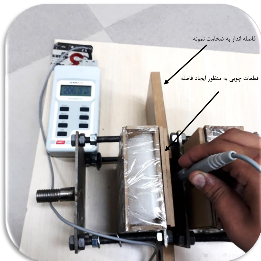
شکل ۲-۱۴- اندازه گیری میدان مغناطیسی بین آهن رباها.
