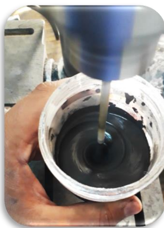
شکل ۷-۲- مخلوط کردن کل مواد تشکیل دهنده با یکدیگر.
