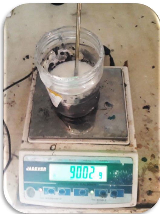
شکل ۵-۲- افزودن پلیمر سیلیکون به مخلوط ذرات آهن و روغن سیلیکون.
