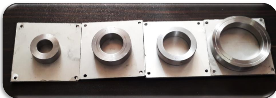
شکل ۱-۲- قالب‌های ساخته شده به منظور قالب گیری MRE.
