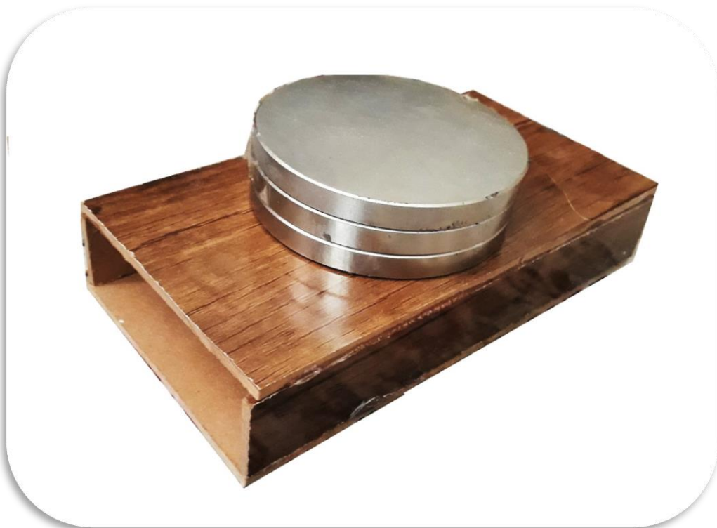
شکل ۲-۱۳- سه عدد آهن ربا نئودیمیوم به هم چسبیده شده به همراه جعبه محافظ.
