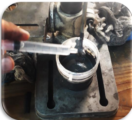
شکل ۶-۲- اضافه کردن هاردنر به مخلوط.
