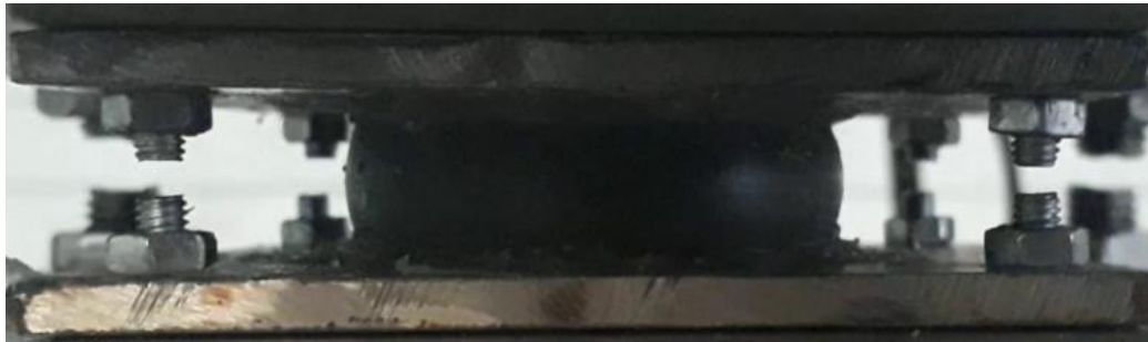
شکل ۱۴-۱- نمونه ی MRE تحت فشار محوری.
