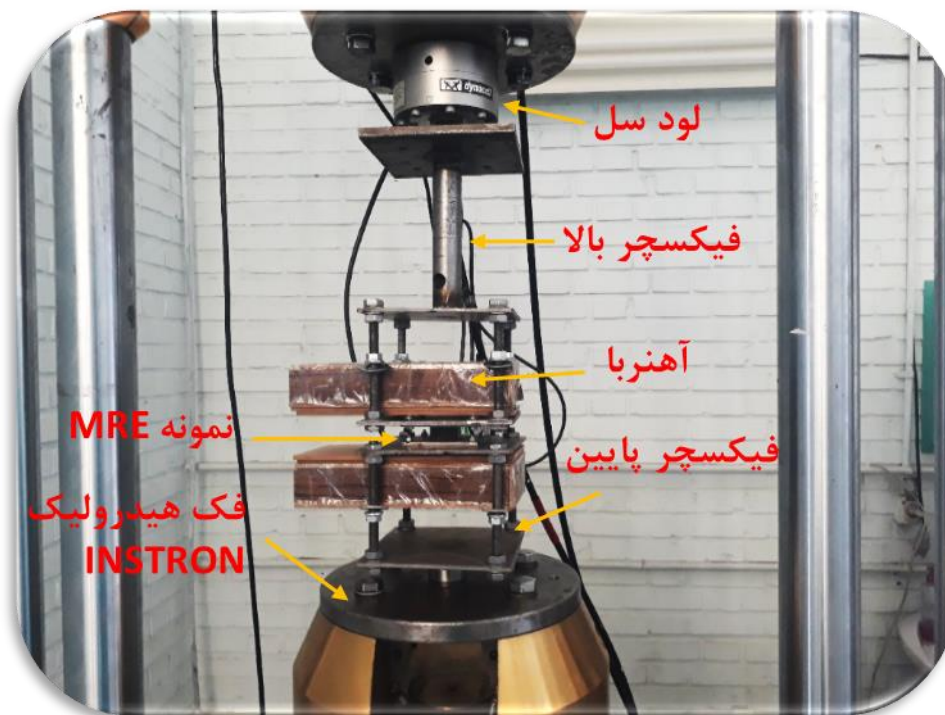
شکل ۳-۲- اجزاء ستاپ آزمایش.
