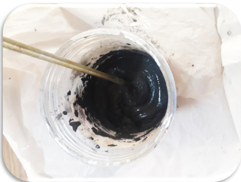
شکل ۴-۲ - پودر آهن و روغن سیلیکون پس از ۵ دقیقه مخلوط شدن.
