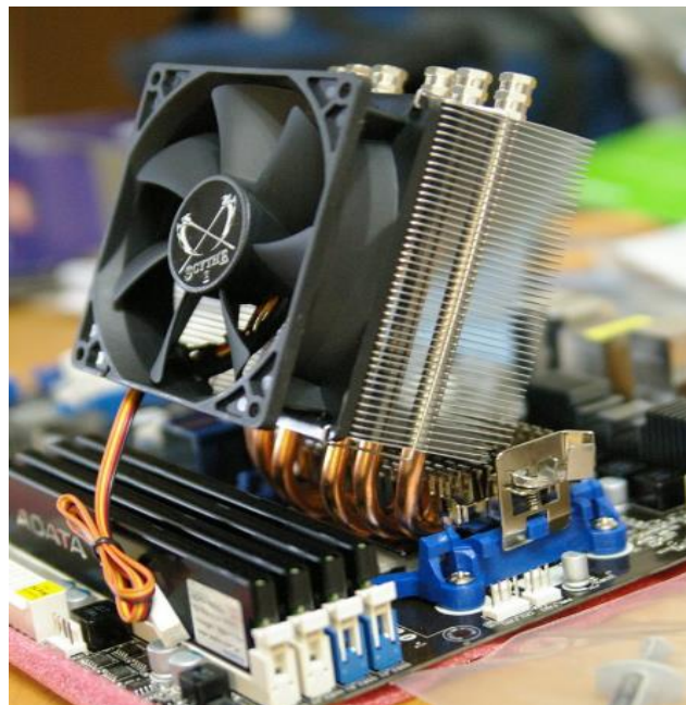
شکل ۴-۱: نمونه‌ای از کاربرد عملی لوله‌های حرارتی در خنک‌سازی سیستم‌های کامپیوتری [۸].
