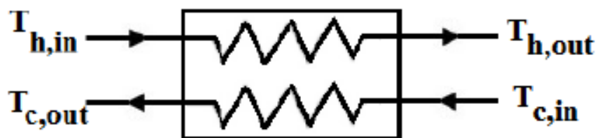
شکل ۳-۴ شماتیک مبدل حرارتی
