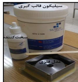
شکل (۸-۳) ماده‌سازی قالب سیلیکونی (سمت راست)، قالب سیلیکونی (سمت چپ).
