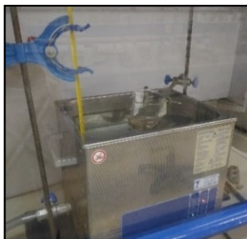
شکل (۳-۵) نحوه قرارگیری بشر حاوی پرکننده‌های نانوساختار و رزین درون حمام فراصوت.
