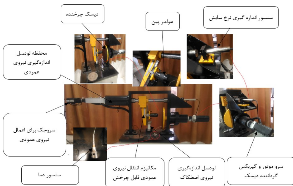
شكل (۳-۱۰) قسمت‌های مختلف دستگاه آزمون سایش.
