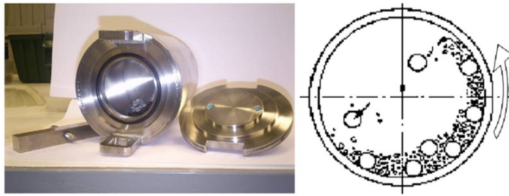
شکل (۷-۱) مکانیزم آسیای گلوله‌ای [۱۶].
