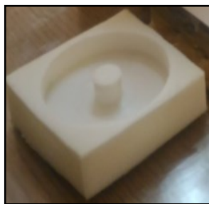
شکل (۸-۳) ماده‌سازی قالب سیلیکونی (سمت راست)، قالب سیلیکونی (سمت چپ).
