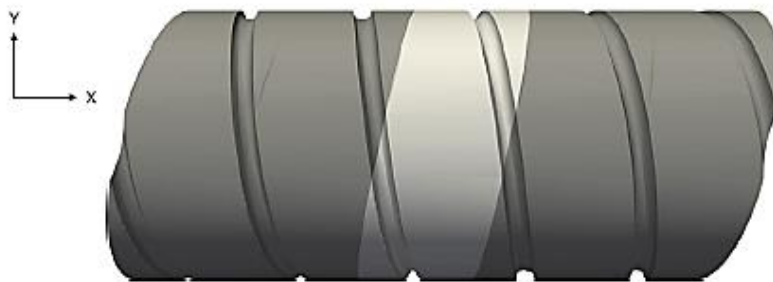
شکل ۱-۱۶ طرح کانال با سطح مقطع دایره‌ای با دندانه مارپیچ [۴۳]
