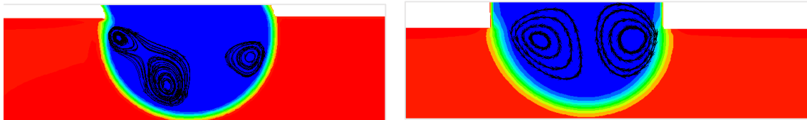
شکل ۴-۳۴: مقایسه خطوط جریان در دو زاویه مختلف در شرایط Ca=0.005 , Q=0.5 , \eta_d/\eta_c = 0.125 , \theta = 60 و \theta = 90
