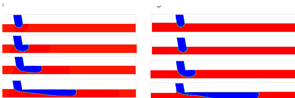
شکل ۳۳-۴ تاثیر زاویه تقاطع در فرایند تشکیل قطره در دو نسبت دبی حجمی در Ca = 0.005 و نسبت لزجت 0.125 و زاویه تقاطع \theta = 80 (الف) Q = 0.5 و (ب) Q = 1.5
