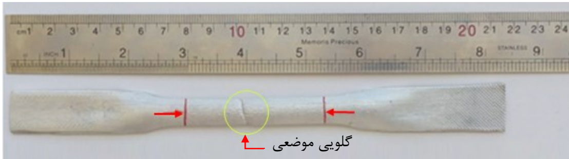
شکل ۴-۲- نمونه آزمون کشش پس از اجرای آزمون و تشکیل گلویی موضعی
