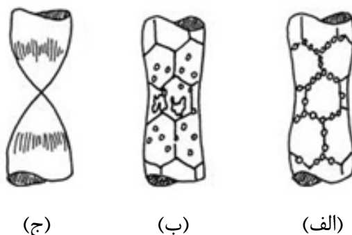
شکل ۲-۳- انواع شکست نرم فلزات تحت تنش یک‌بعدی (الف) جوانه‌زنی و رشد حفره (مرزدانه‌ای)، (ب) جوانه‌زنی و رشد حفره (درون‌دانه‌ای)، (ج) گلوپی شدن [۵۱]
