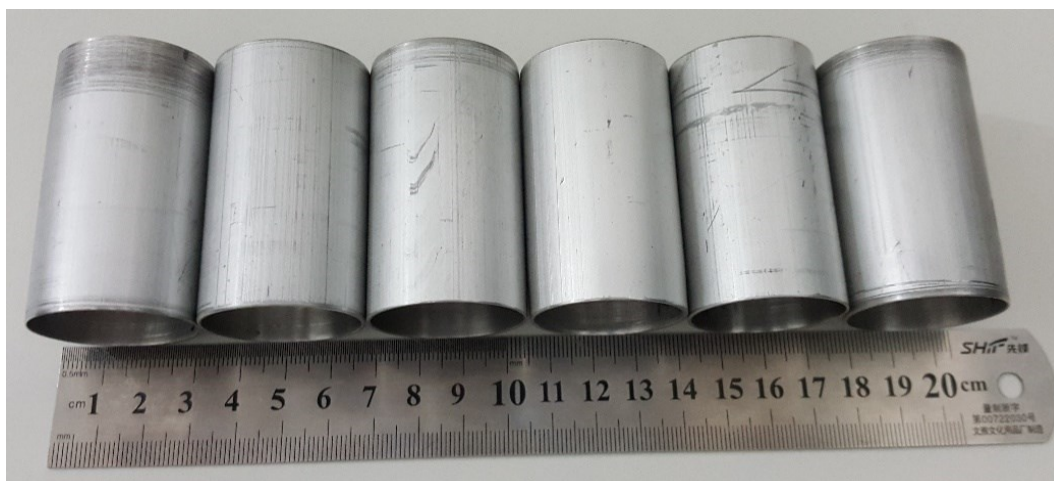
شکل ۲-۴- نمونه‌های آماده شده پس از داخل تراشی
