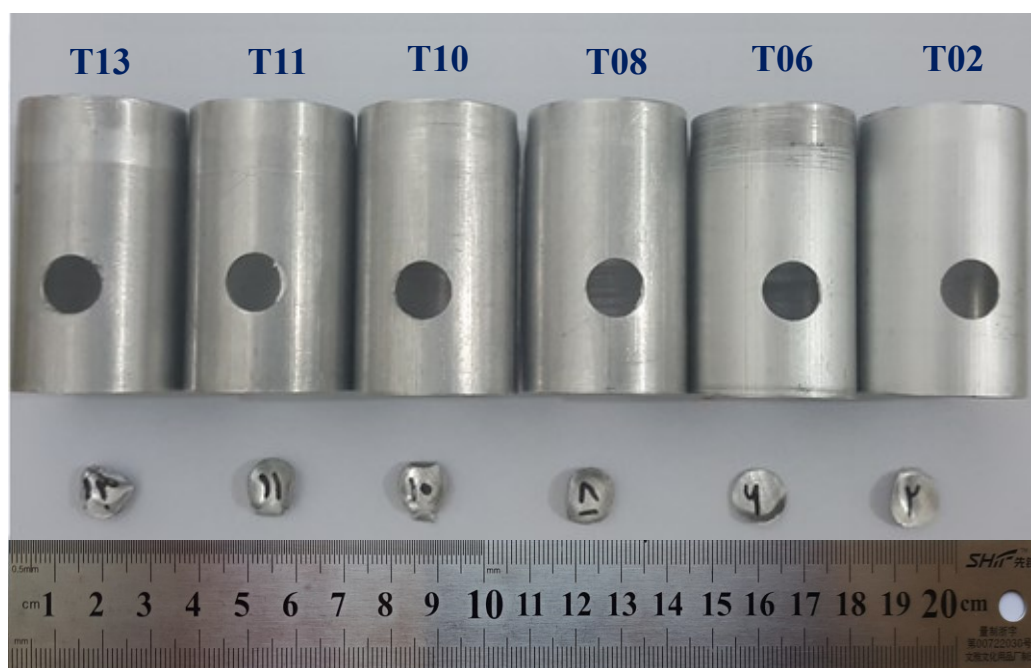
شکل ۳۳-۴ نمونه‌های سالم سوراخ کاری لوله با ابزار الاستومری
