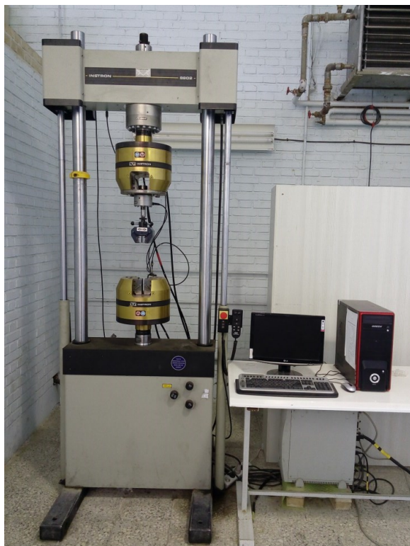
شکل ۲-۲- دستگاه اینسترون ۸۸۰۲ به همراه سیستم کنترل رایانه‌ای
