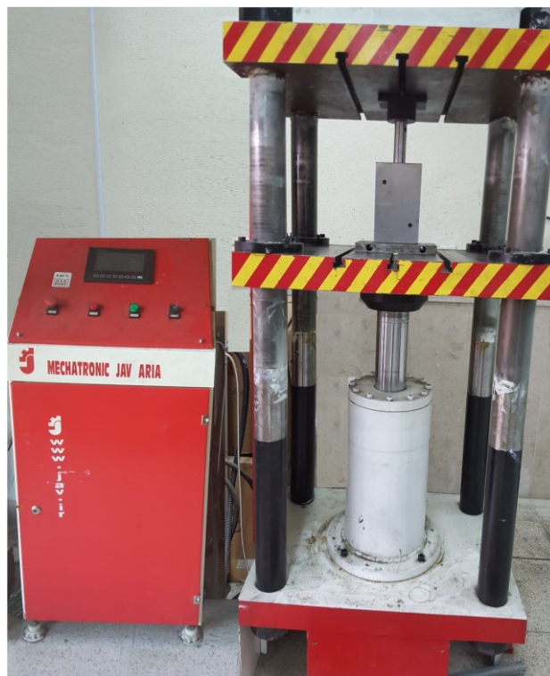
شکل ۲-۶- دستگاه پرس هیدرولیکی ۱۰۰ تن ژاو-آریا به همراه واحد رایانه‌ای متصل به آن و مجموعه قالب نصب‌شده بر روی میز دستگاه
