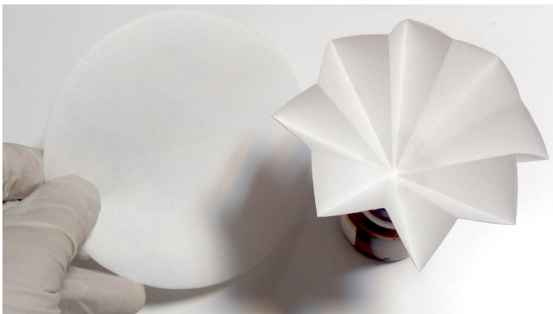
شکل ۸-۳ استفاده از فیلتر کاغذی به منظور تبلور مجدد پودر نیپام
