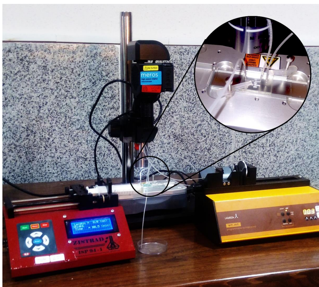
شکل ۵-۱ تصویر اتصال میکروکانال به پمپ‌های سرنگی و قرارگیری آن تحت میکروسکوپ دیجیتال
