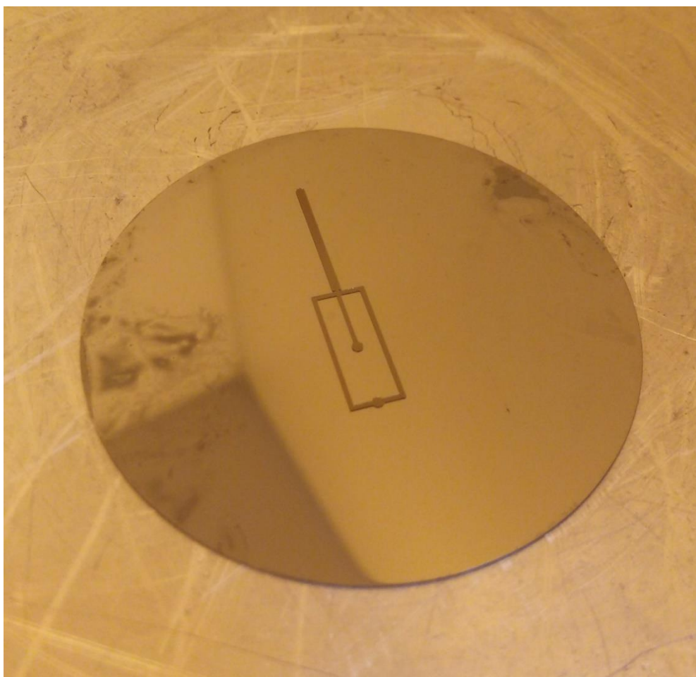
شکل ۳-۴ قالب میکروکانال ساخته شده پس از پخت نهایی
