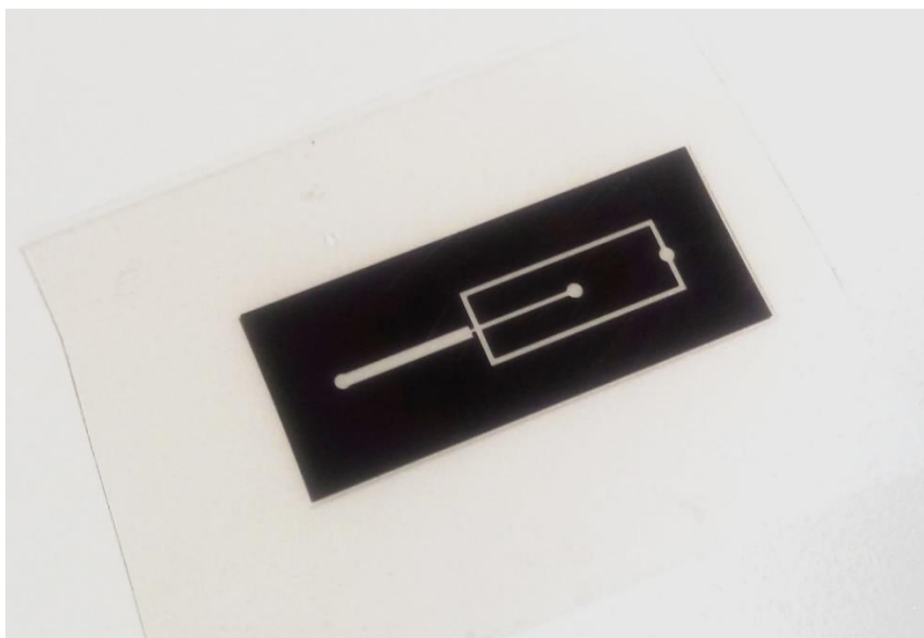
شکل ۳-۳ تصویر فوتوماسک چاپ شده به منظور ساخت قالب میکروکانال به روش فوتولیتوگرافی
