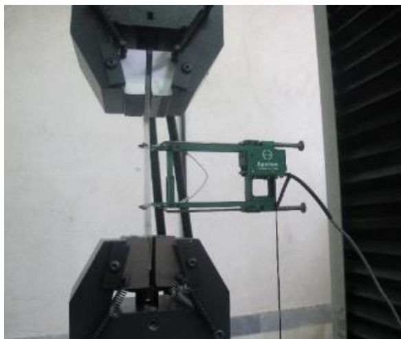
شکل (۳-۱۹) دستگاه آزمون کشش، نمونه تحت کشش و اکستنسومتر بسته شده بر روی آن برای به دست آوردن کرنش
