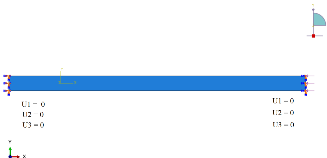
شکل (۴-۳۷) نحوه‌ی اعمال شرایط مرزی و بارگذاری در مدل المان محدود مدل تیر
