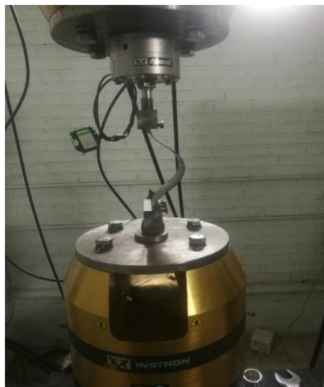
شکل (۳-۱۸) ورق کامپوزیتی تحت بارگذاری فشاری
