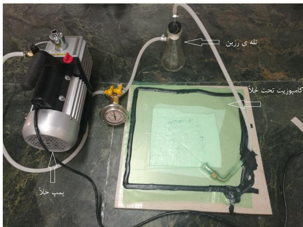
شکل (۳-۱۵) ساخت ورق کامپوزیت به کمک لایه چینی دستی تحت فشار خلأ
