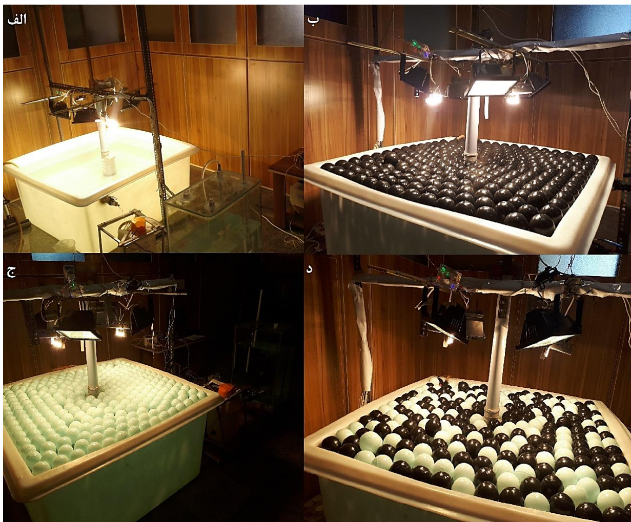
شکل ۲-۴: تصویر واقعی تجهیزات آزمایشگاهی و حالت‌های مختلف پوشش‌دهی جهت ارزیابی نرخ کاهش تبخیر سطحی: الف) مخزن بدون پوشش ب) پوشش‌دهی با توپ‌های محافظ سیاه ج) پوشش‌دهی با توپ‌های محافظ سفید د) پوشش‌دهی ترکیبی.
