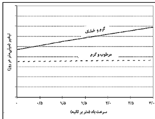
شکل ۱-۲: رابطه بین تبخیر از سطح آب با سرعت باد در شرایط آب و هوایی گرم و خشک و مرطوب [۶].
