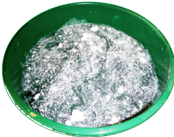
شکل ۸-۱: تصویر چگونگی قرارگیری واترسیور روی سطح آب [۱۰].
