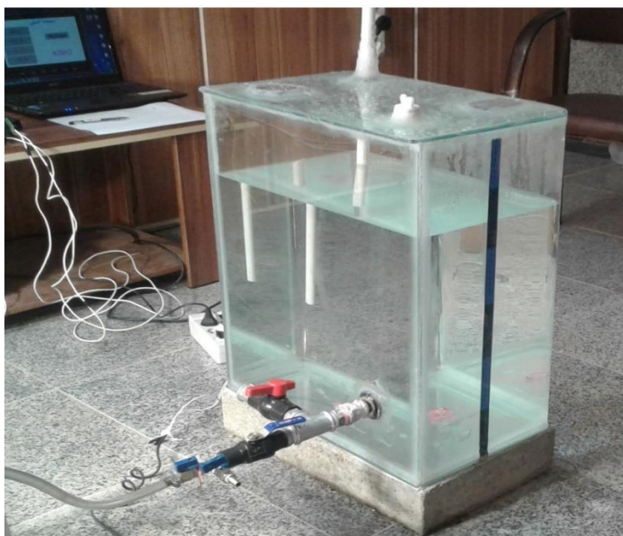
شکل ۲-۳: تصویر واقعی از ماریوت باتل مورد استفاده در پژوهش حاضر.
