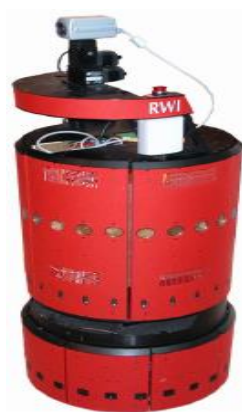
شکل ۳-۴: دوربین و فاصله یاب لیزری نصب شده بر روی ربات متحرک [۳۸]
