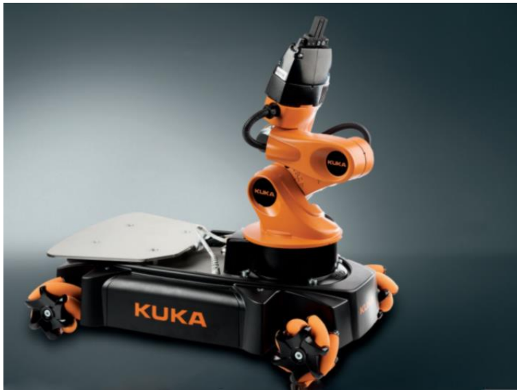
شکل ۳-۴: ربات متحرک کوکا (YOU BOT) [۴۱]
