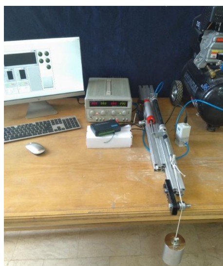
شکل (۳-۳) چیدمان ثانویه، استفاده از وزنه بجای جک پنوماتیکی
