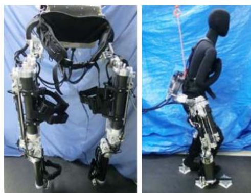
شکل (۱۰-۱) ربات توانبخشی پوششی زُر که از عملگر هیبریدی بهره برده است [۱۱]
