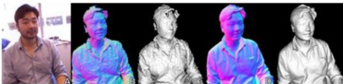
شکل (۳-۲): (الف) تصویر RGB، (ب) نرمال های سطح و (پ) سطح بازسازی شده نویندار. (ت) و (ث) نرمال های سطح و مدل Phong Shaded مدل سه بعدی کینکت فیوژن را نشان می دهد [۶].
