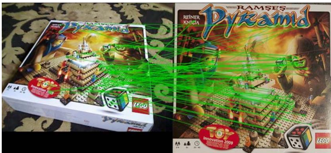
شکل (۴-۶): ویژگی‌های مناظر بین دو تصویر بعد از تطبیق ویژگی (که شامل تطبیق‌های اشتباه هم هست) [۳۳]
