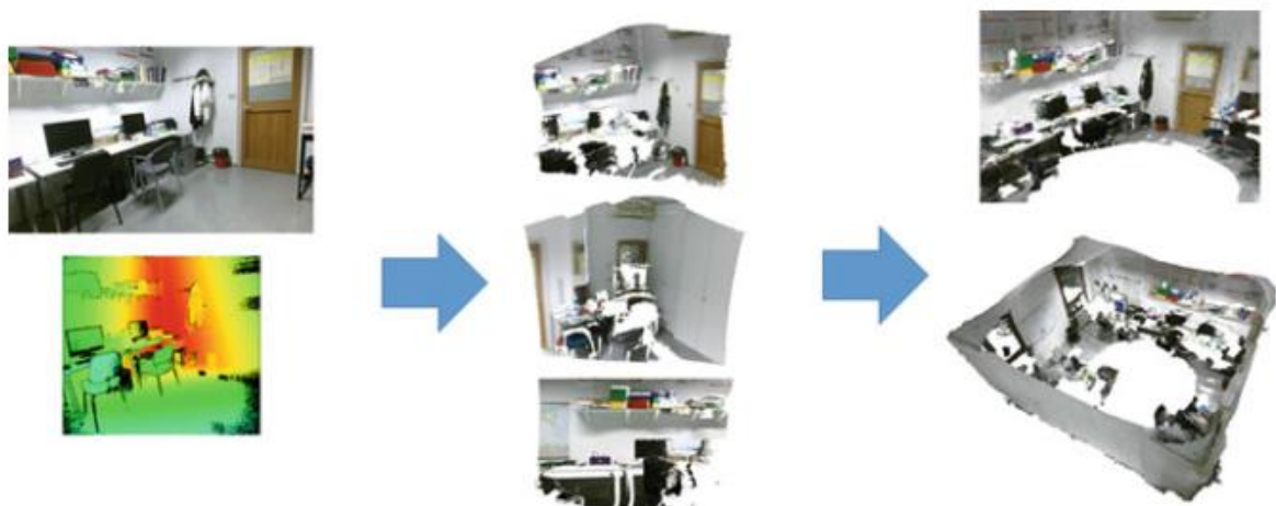
شکل (۳-۱) مدل سه بعدی محیط اتاق، که به وسیله اسکن سه بعدی ساخته شده است. این مدل اجازه بازرسی در ابعاد واقعی را می‌دهد
