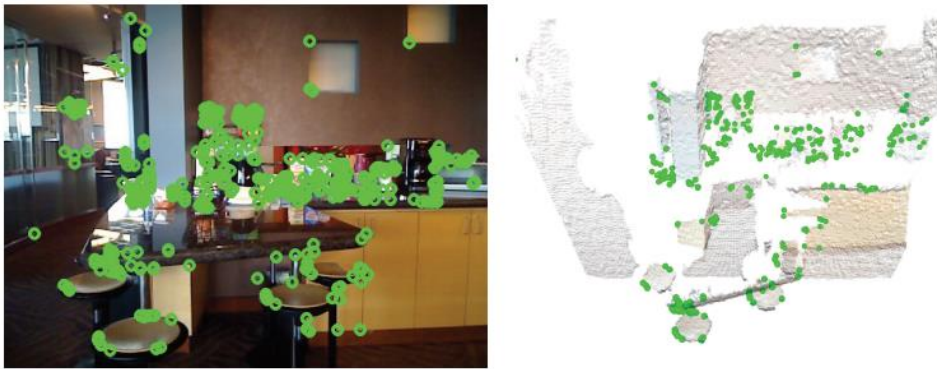
شکل (۲-۵): (سمت چپ) نقاط ویژگی پراکنده بدست آمده به وسیله روش FAST (سمت راست) همان ویژگی‌ها در حالت سه‌بعدی نمایش داده شده‌اند [۸].
