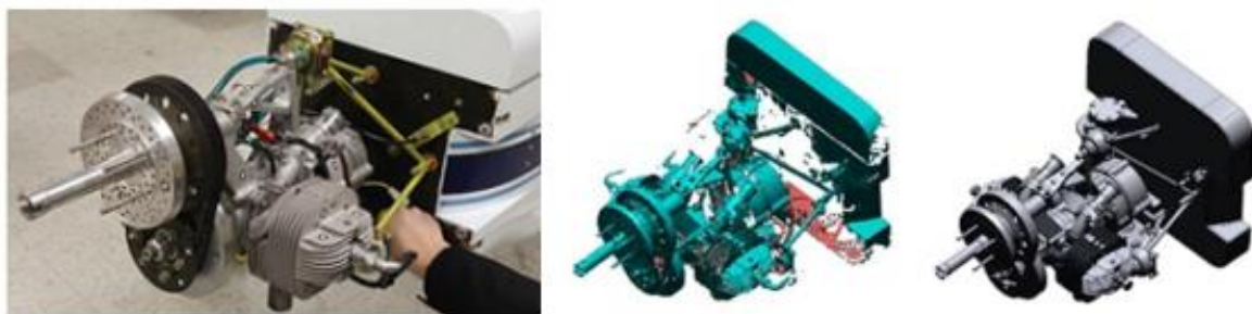
شکل (۱-۲) (سمت چپ) مهندسی معکوس یک موتور واقعی (وسط) به وسیله اسکن داده‌ها (سمت راست) مدل CAD ساخته شده
