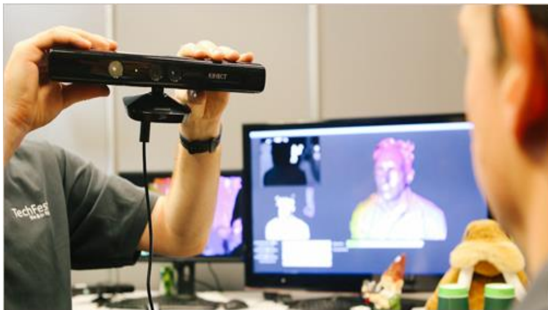
شکل (۴-۳): داده‌های RGB-D که توسط سنسور RGB-D در فاصله بین ۰٫۸ متر و ۳٫۰ متر از سطح بدست می‌آید.
