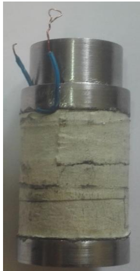
شکل ۴-۵ هسته سیم‌پیچ شده برای تولید میدان مغناطیسی
