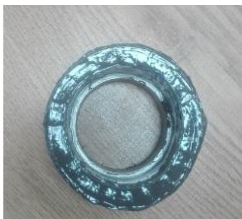
شکل ۳-۷ مخلوط در قالب ریخته شده و آماده پخت
