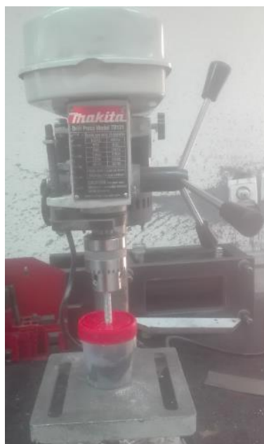
شکل ۳-۵ مخلوط کردن ذرات آهن و روغن سیلیکون به مدت ۵ دقیقه
