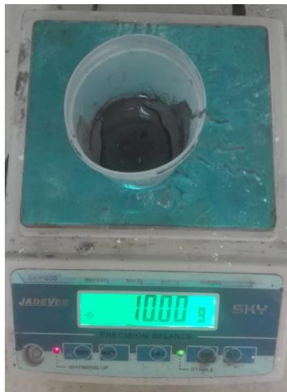
شکل ۳-۴ اضافه کردن ۱۰ گرم روغن سیلیکون به ذرات آهنی
