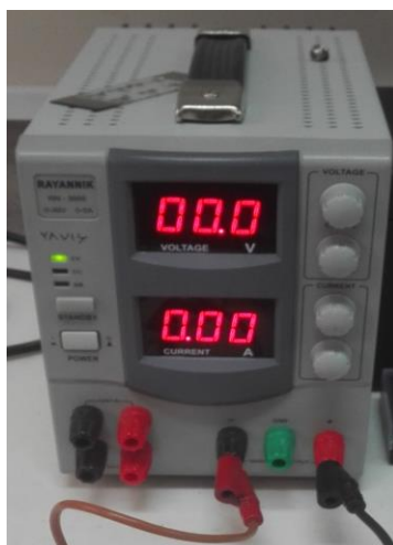
شکل ۴-۴ منبع تغذیه برای اعمال جریان ورودی به سیم پیچ
