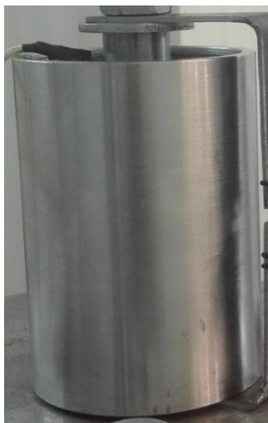
شکل ۱-۴ دسته‌موتور بعد از مونتاژ شدن
