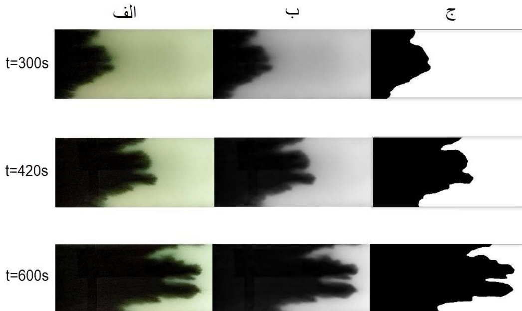
شکل ۳-۶ ویرایش و پیش‌پردازش نمونه ایی از آزمایشات. الف) تصویر اصلی جدا شده از فیلم. ب) اعمال فیلتر و حذف نویزهای نمک و فلفل توسط متلب ج) باینری کردن تصویر فیلتر شده توسط متلب
