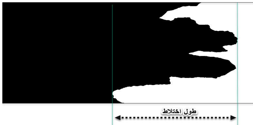
شکل ۳-۱ شماتیک طول اختلاط
