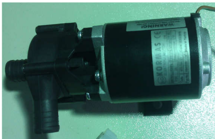
شکل ۳-۱۲: پمپ دی سی ۲۴ ولت با دبی حداکثری ۲۰ لیتر بر دقیقه
