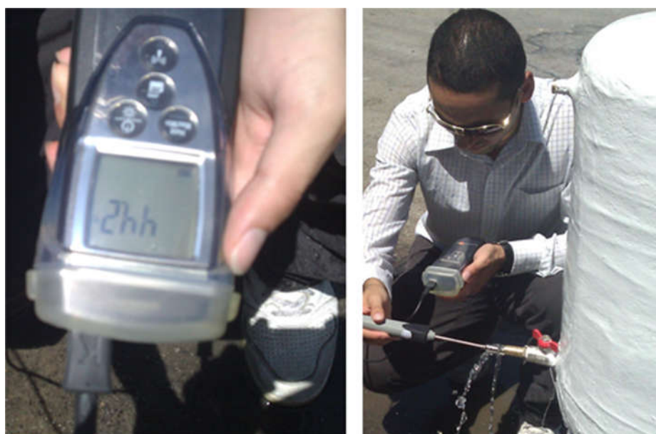
شکل ۴-۴: اندازه گیری دمای مخزن بوسیله ی نمونه گیری از آن
