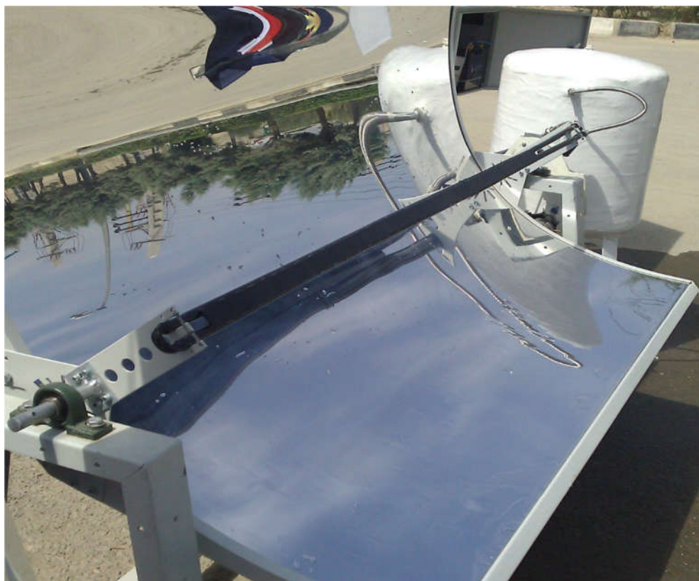
شکل ۳-۵: اعوجاج خفیف در آینه مقعر ورق پلکسی خصوصاً در گوشه آینه
