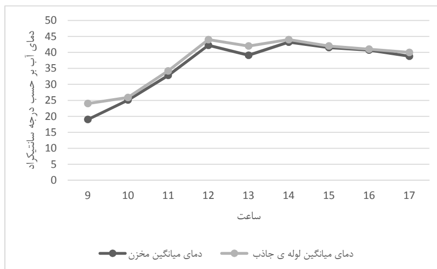
شکل ۴-۸: نمودار دمای متوسط مخزن و لوله ی جاذب بر حسب درجه سانتی گراد در آزمایش اول
