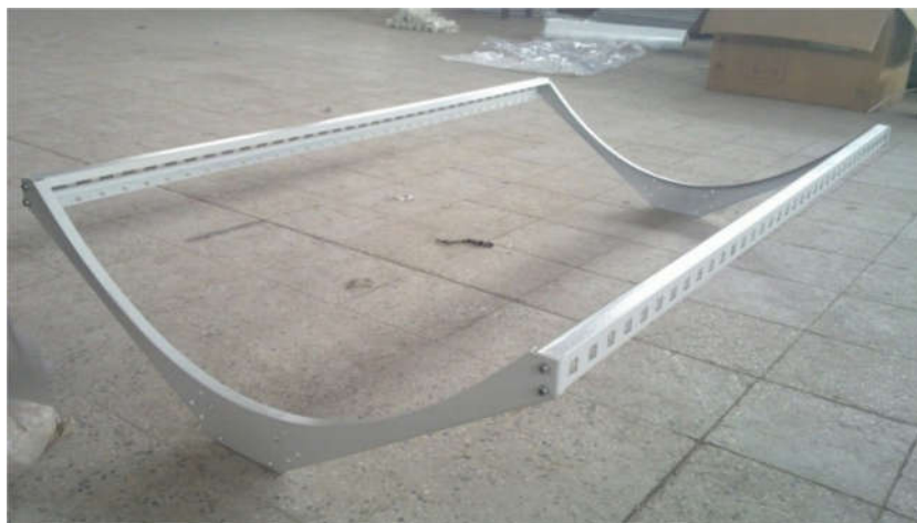
شکل ۳-۳: پایه ها و نشیمن گاه پلکسی سهموی شکل، برش و خم کاری شده بوسیله ی CNC
