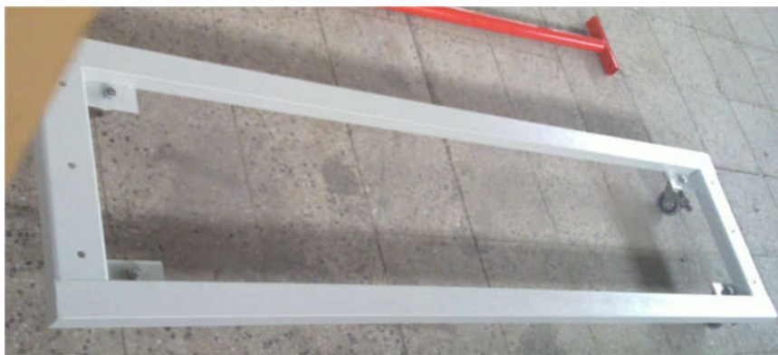
شکل ۳-۲: پایه نگه دارنده کلکتور سهموی - خطی
