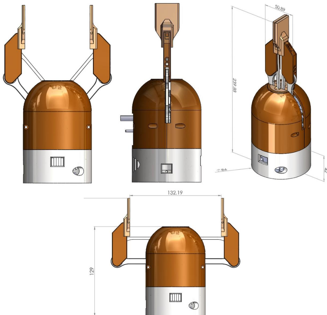
شکل ۴-۶ نمونه‌ی طراحی شده در نرم‌افزار سالیدورکز ۱ تمامی ابعاد به میلی‌متر می‌باشد.
