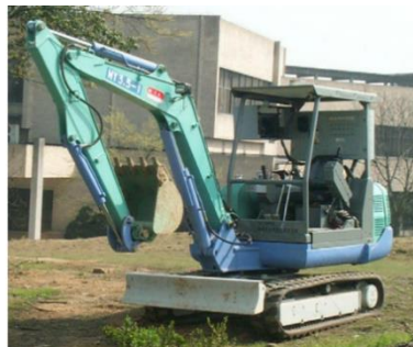
شکل ۱-۱۵ مدل سازی یک لودر به صورت بازوی رباتیک سری با عملگرهای هیدرولیکی [۵۵]
