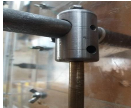
شکل ۳-۲۲: قطعه فلزی ساخته شده برای زاویه دهی
