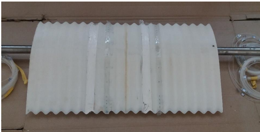
شکل ۳-۲۱: شکل نهایی ساخته شده ایرفویل موج دار S809 با پرینتر سه بعدی
