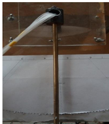
شکل ۳-۲۴: سیستم زاویه دهی و تنظیم زاویه صفر درجه
