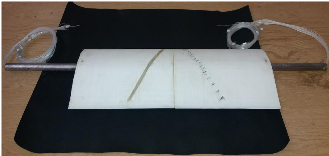
شکل ۳-۱۷: شکل نهایی ساخته شده مدل ایرفوایل استاندارد S809 با پرینتر سه بعدی
