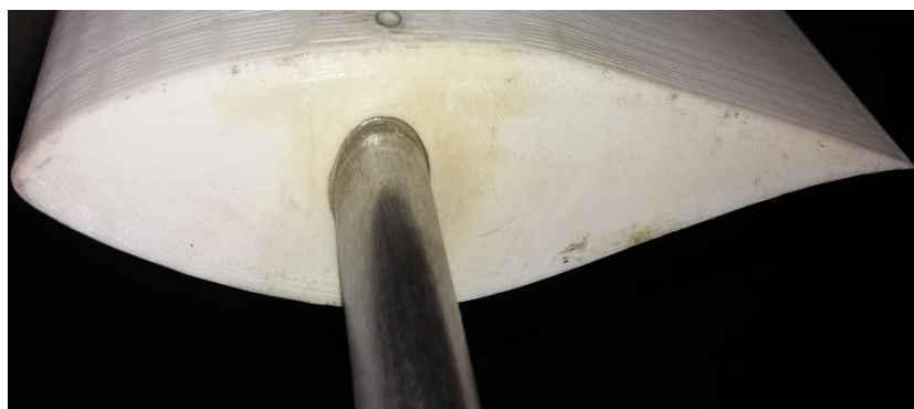
شکل ۳-۱۸: شفت فلزی و مقطع ایرفوایل استاندارد S809
