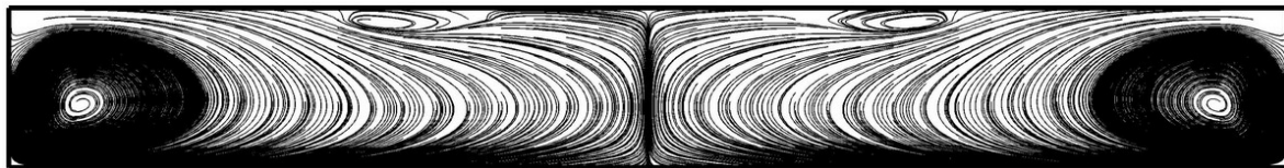
شکل (۵-۱۶): خطوط جریانهای ثانویه برای جریان خزشی در \kappa = 0.125 ، \Psi_1 = 2 ، \delta = 0.5 و در مقادیر مختلف \Psi_2
