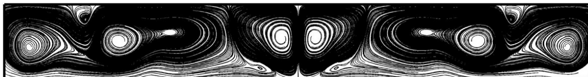
شکل (۵-۳۰): خطوط جریانهای ثانویه برای جریان اینرسی سیال نیوتنی در \delta = 0.15 و \kappa = 0.125
