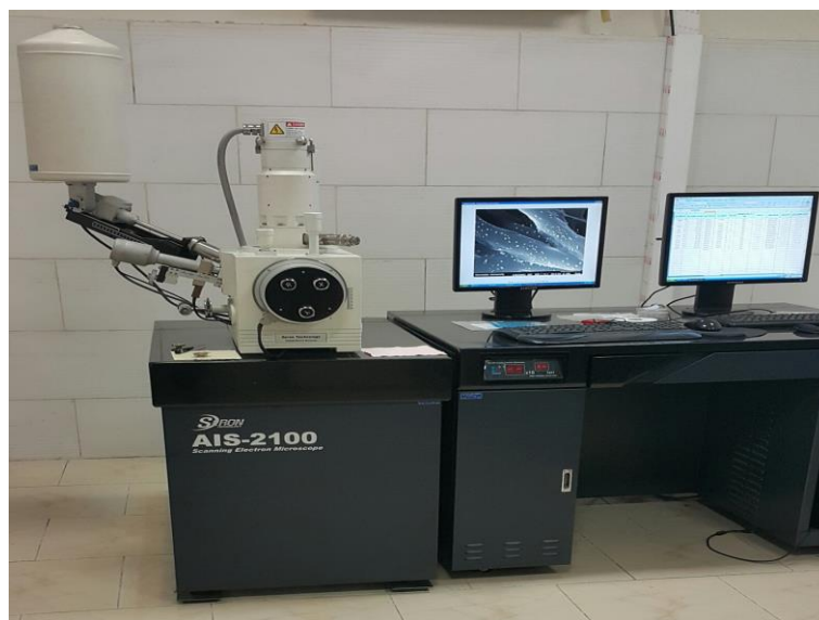
شکل ۲-۴- نمایی از دستگاه SEM جهت تعیین مشخصات پودر مورد استفاده
